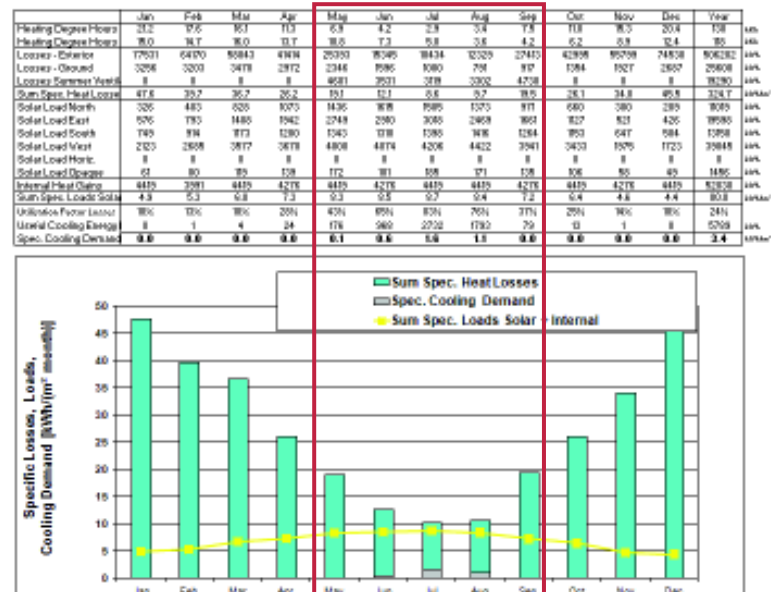
Fig. 5.12 – Consum de energie pentru încălzire și răcire în cazul vitrajului cu perne de aer ETFE cu o cameră
