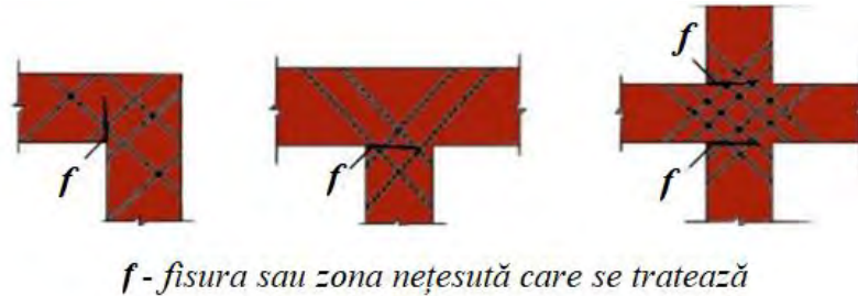
Figura 3.46 Injecții armate la colțuri, ramificații și intersecții [9]
