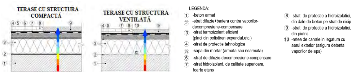
Fig. 3.15a Soluții cu îndepărtarea straturilor existente[47]
