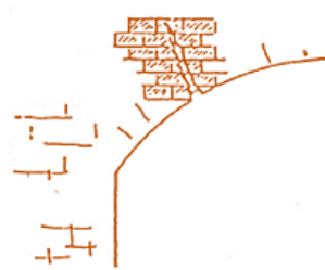
Figura 3.73 Reparații cu strepi din cărămidă [5]
