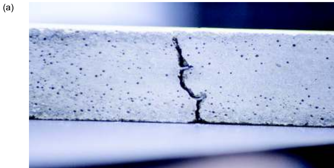
Figura 4.11 – Modul de cedare (b) și suprafața de rupere (b) al epruvetei R1-O1. Aspectul R2-P1 după separarea părților de prismă.
