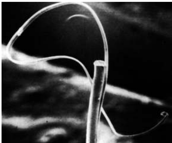
Figura 2.8 – Modul de ruperea la întindere a fibrelor fragile; (a) fibră de sticlă – rupere având un singur plan de clivaj (despicare paralelă cu rețeaua structurii cristaline); (b) fibra de sticlă – mai multe zone și planuri de rupere; (c) fibră ceramică – carbură de siliciu cu deviere la rupere; (d) Fibră de elastan sau spandex.
