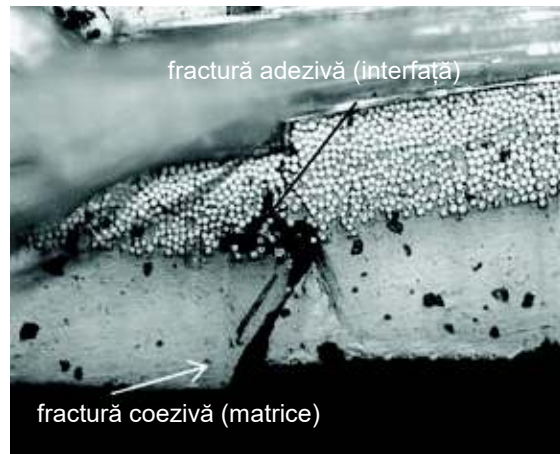
Figura 2.18 – Compozit stratificat armat cu fibre de aramid; (a) Modul de rupere a fibrei de aramid, Kevlar 29 la întindere; (b) Fracturi multiple: fractură coezivă (în matrice) și adezivă (între matrice și fibră). Propagarea fisurilor în matrice provoacă slăbirea și fisurarea în zona de interfață matrice-fibră. Acest tip de fractură se numește fractură adezivă.
