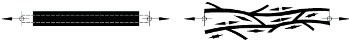
Figura 2.27 – Fibre de armare mono-filament și fibrilate. Distribuția eforturilor de-a lungul fibrelor.
