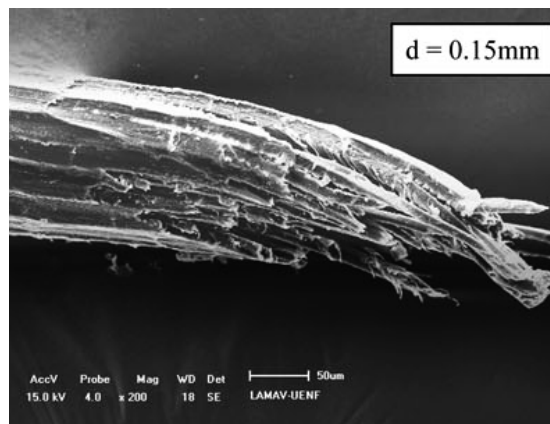
Figura 2.20 – Imagini SEM: modul de rupere a fibrelor naturale la întindere: (a) sisal; (b) bambus; (c) nucă de cocos.
