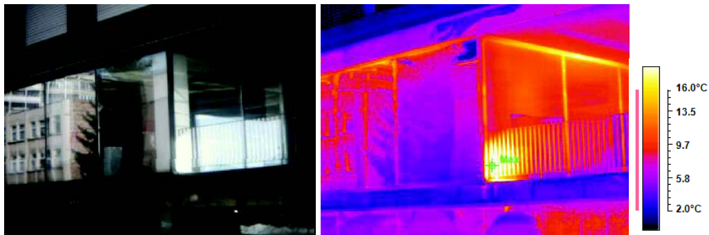
Fig. 6.7 Suprafața exterioară a fațadei SV (zonă acces principal) (a) imagine în vizibil (b) hartă termografică
