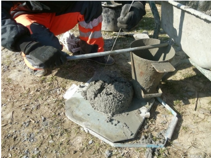
Măsurarea tasării betonului proaspăt la stația de betoane și pe șantier la locul punerii în operă Proiect de reabilitare CF Simeria-Vintu de Jos
