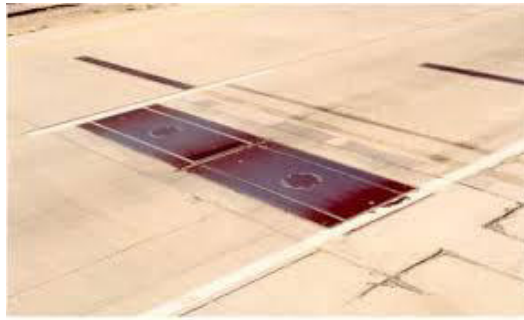
Fig. 3.32 Celule hidraulice de încărcare (sursa imagine: [61])
