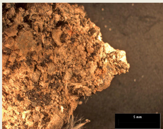
Fig. 4.9. Fascicule de fibre ce ies din goluri datorită ruperii mecanice a probei
