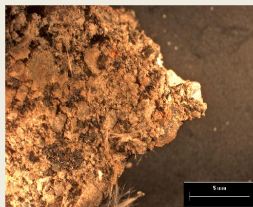
Fig. 4.4. Fascicule de fibre anrobate înglobate în sistemul polifazic reciclat
