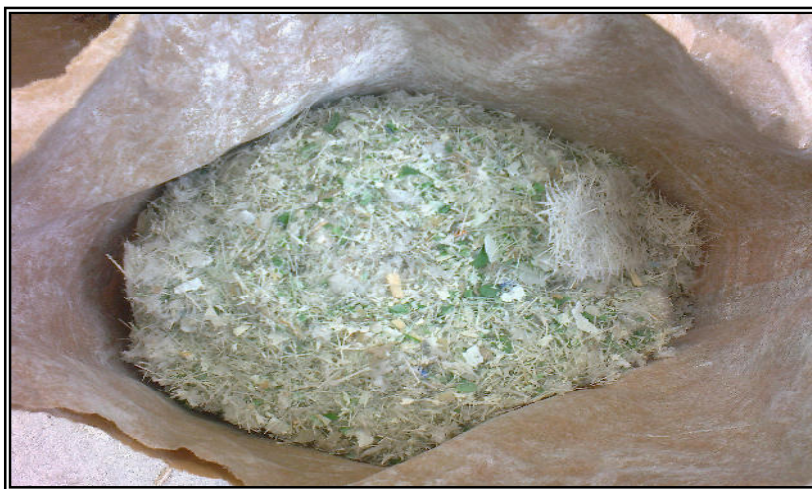
Fig. 2.2. Fibre din sticlă și deșeurile de fibră de sticlă în amestec cu rășini poliesterice după măcinare
