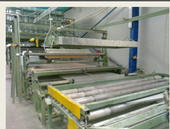
Fig. 6.5. Uniformizarea stratului de fibre cu ajutorul tamburilor rotative
