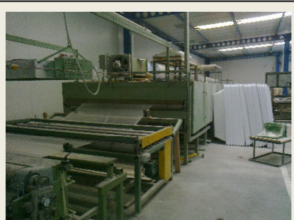
Fig. 6.6. Înfășurarea covorului de fibre fixate cu rășină poliesterică pe folia din polietilenă
