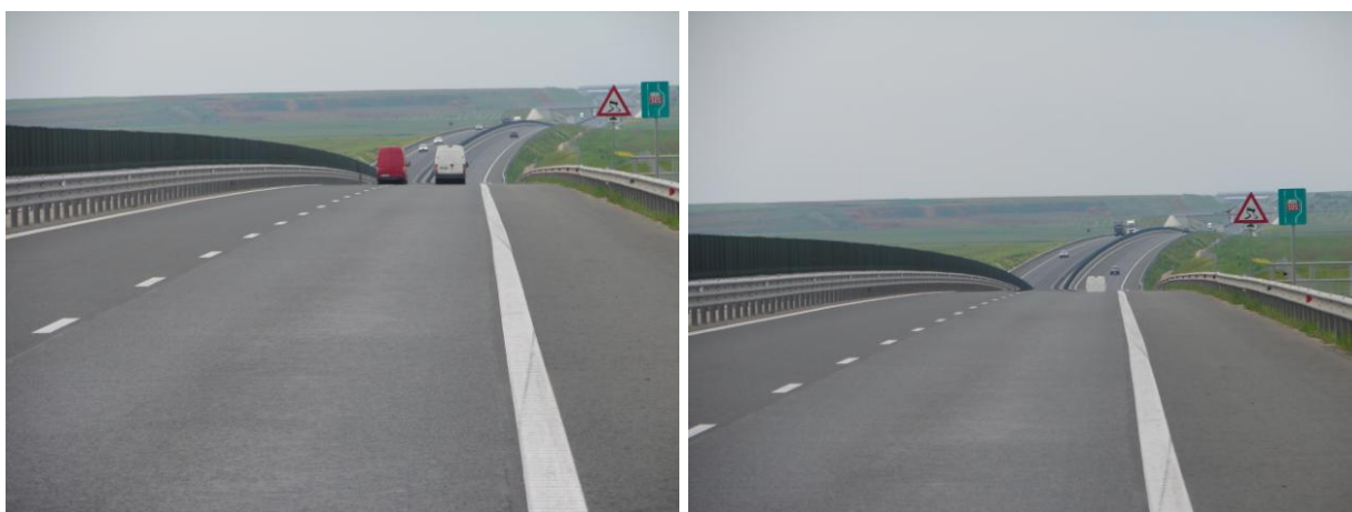
Figura 3 – Pierderea din câmpul de vizibilitate a unui vehicul care circulă în același sens
