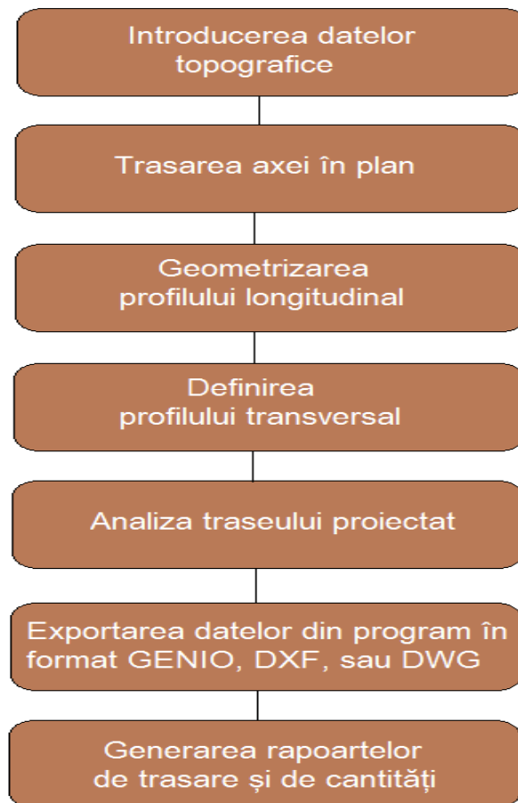
Figura 2. 24 Principalele etape de lucru în MX Road
