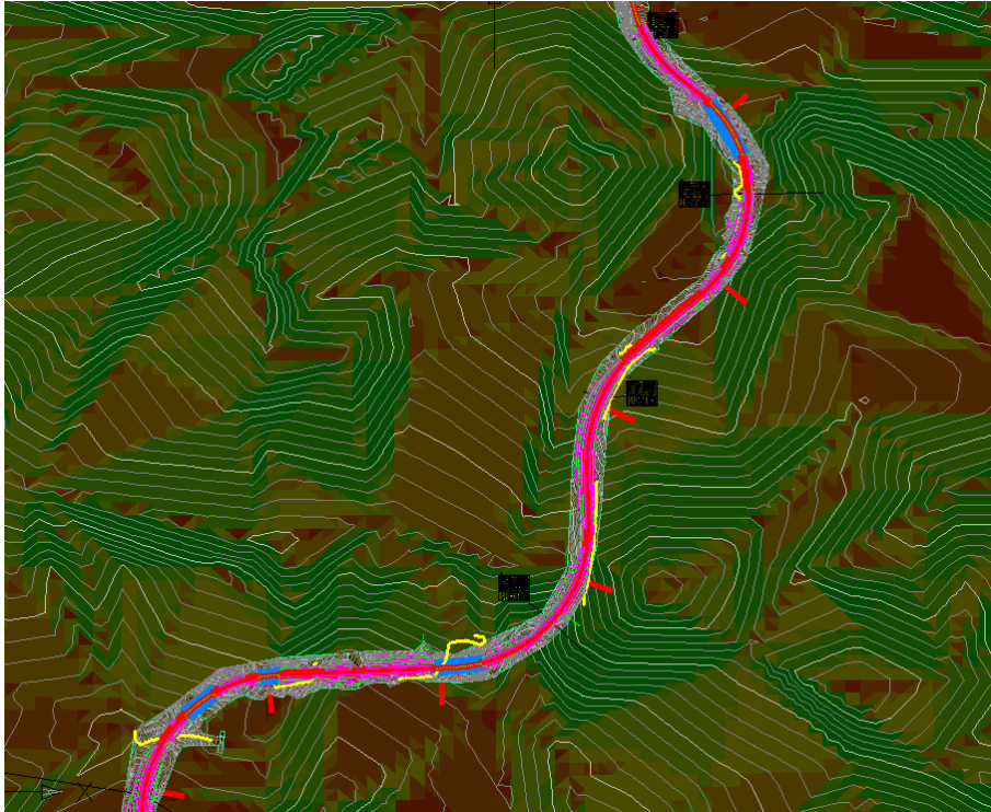
Figura 3. 3 Completarea informațiilor din ridicarea topografică prin suprafețe importante din Google Earth în Civil 3D [35]
