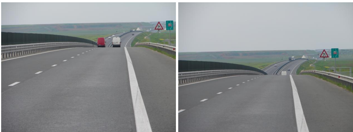
Figura 1.6 Pierderea din câmpul de vizibilitate a unui vehicul care circulă în același sens [74]
