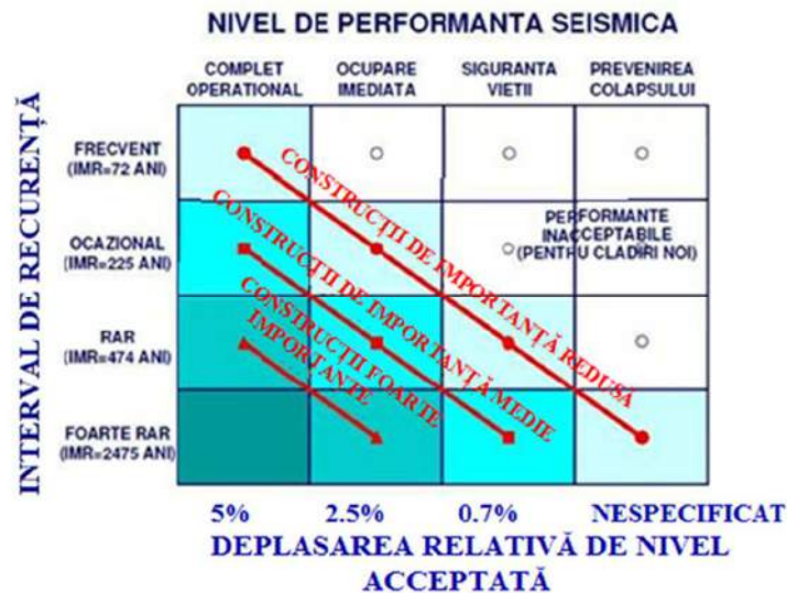
Figura 4.4-5 Relația nivel de performanță seismică – intensitate seismică
