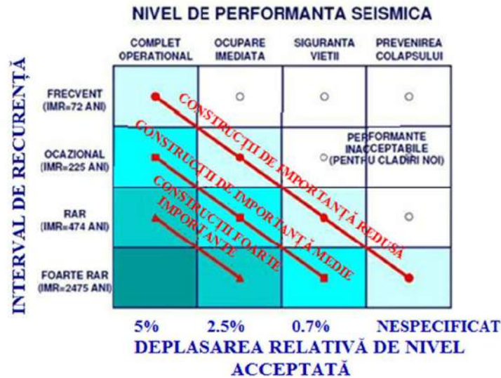
Figura 3.2-14 Relația nivel de performanță seismică – intensitate seismică
