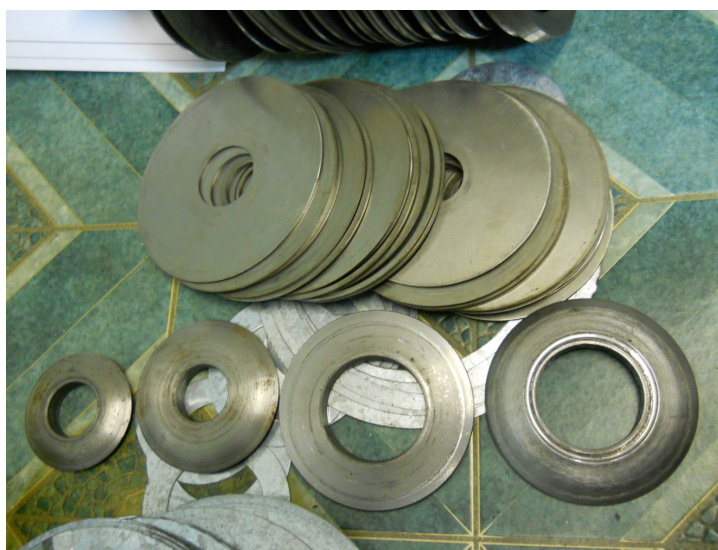
Fig. 3.2 Elemente componente ale amortizorului ȘERB C-194
