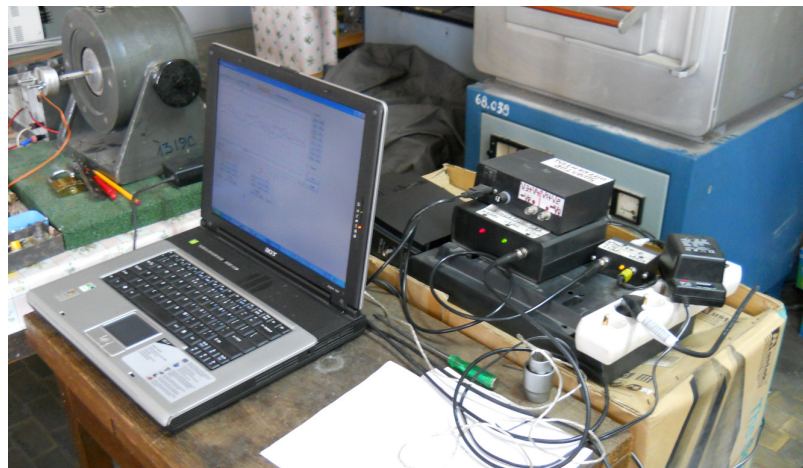
Fig. 3.12 Interfața și sistemul de calcul necesar preluării și procesării datelor experimentale
