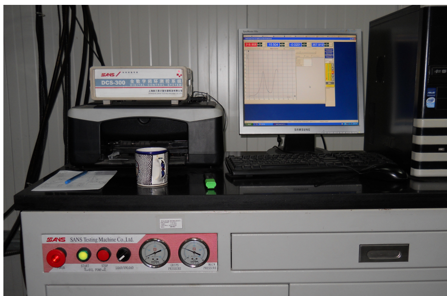
Fig. 3.4 Echipamentul de comandă, control și măsurare al mașinii de testat SANS
