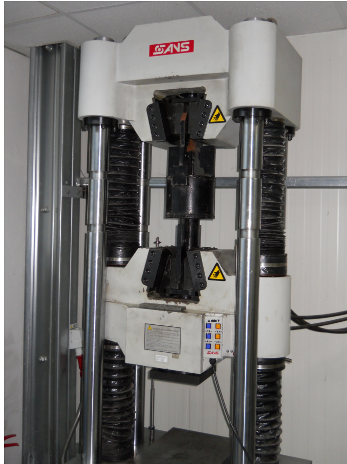
Fig. 3.3 Amortizorul ȘERB C-194 montat pe mașina de testat universală SANS
