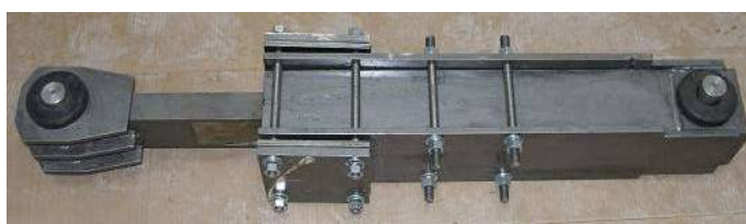
Fig 2.23 Dispozitiv telescopic ȘERB-TEL*600-300 (stânga) și caracteristica sa de histerezis (dreapta) [136]
