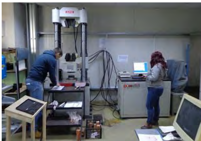
Fig. 6.13 Mașina de testat universală SANS și echipamentul de comandă în timpul testelor
