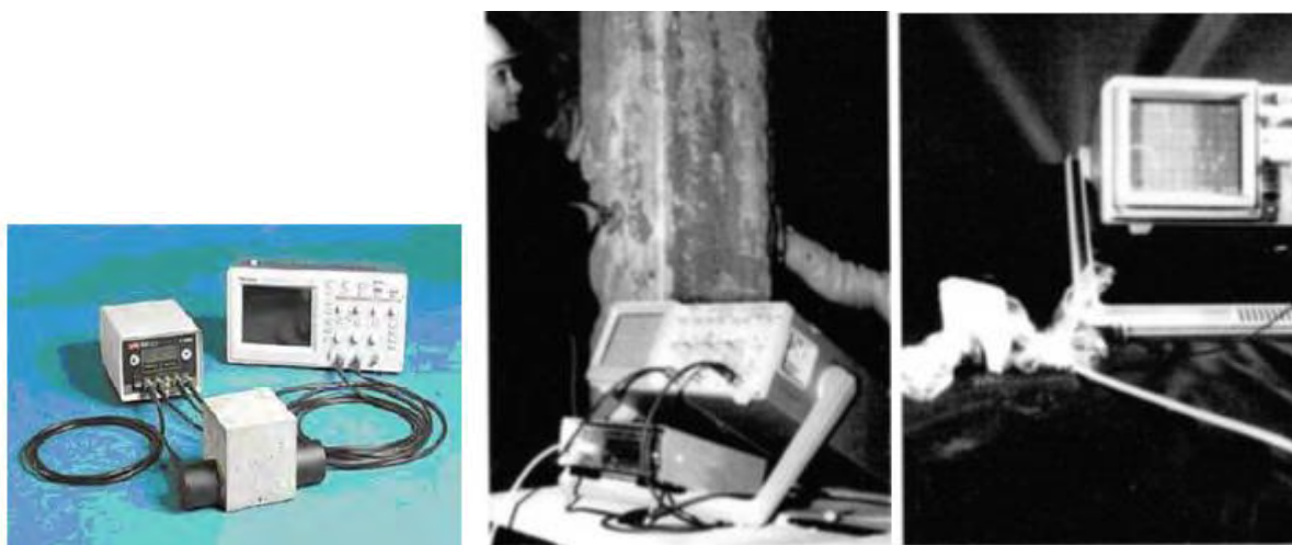
Fig.2.15 (a) Aparatura pentru metoda ultrasonică (b) Investigarea unui stâlp cu metoda ultrasonică (c) Măsurători prin metoda ultrasonică pentru determinarea caracteristicilor mecanice ale mortarului [31]
