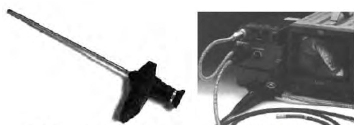
Fig. 2.21 a) Borescop cu fibre optice rigide și fibroscop cu fibre optice flexibile și cu monitor [48]
