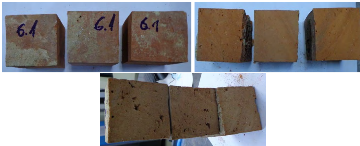
Fig. 6.66 Extragerea epruvetelor cubice din proba de caramida 6.1.
