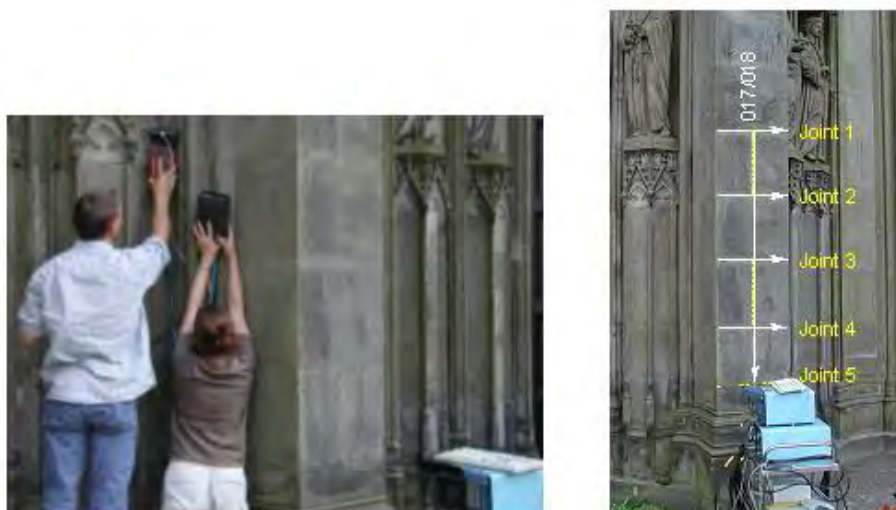
Fig. 2.19 În stânga: măsurătorile radar în apropierea pilon cu antena de 1,5 GHz. Dreapta: Poziția articulațiilor (galben) și urme radar (albe) la suprafața unui stâlp [47]
