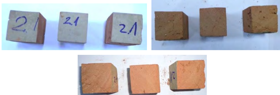
Fig. 6.26 Extragerea epruvetelor cubice din proba de cărămidă 2.1
