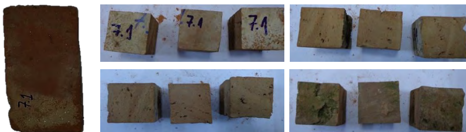
Fig. 6.12 Extragerea epruvetelor cubice din proba de cărămidă 7.1
