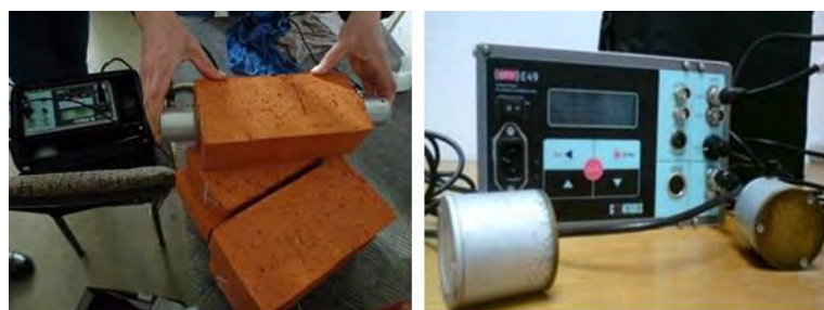
Fig. 6.6 Caramidă nouă supusă testelor UPV cu aparatul UPV E49
