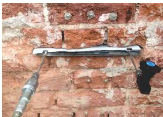
Fig.2.24 Efectuarea testului pentru stabilirea efortului in-situ, s=0.52 \text{ N/mm}^2 [49]
