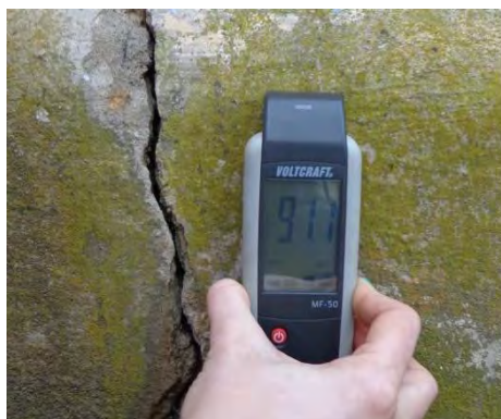
Fig. 6.4 Măsurarea umidității cu higrometrul MF-50 VOLTcraft
