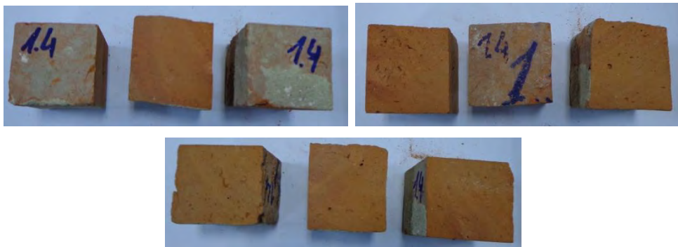
Fig. 6.19 Extragerea epruvetelor cubice din proba de cărămidă 1.4
