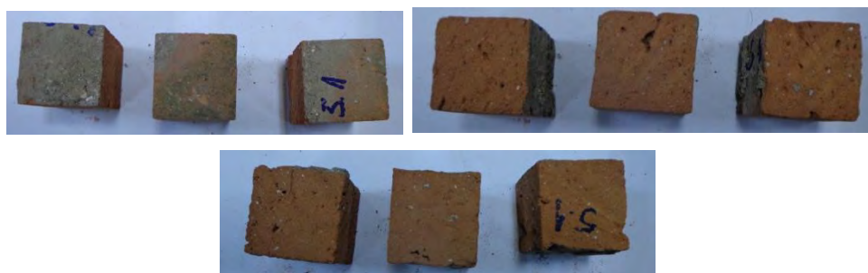
Fig. 6.56 Extragerea epruvetelor cubice din proba de cărămidă 5.1.
