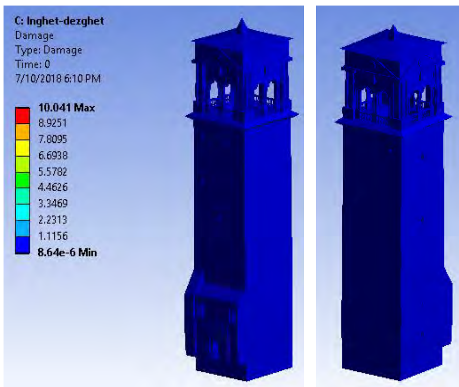
Fig.7.96. Harta de deteriorare pentru 20490 cicluri de încărcare (900 de ani)
