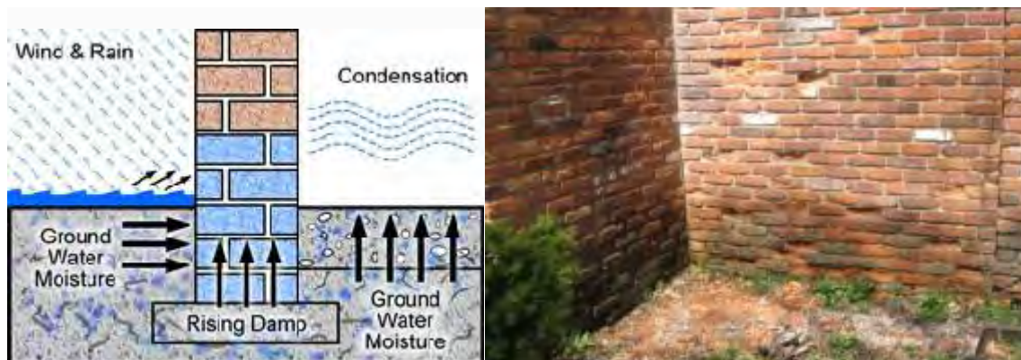
Fig. 2.2. Elemente din zidărie afectate de umiditate [4]
