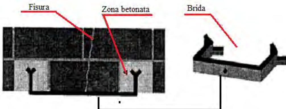
Fig. 8.12 Remedierea fisurilor cu bride din oțel lat [9]
