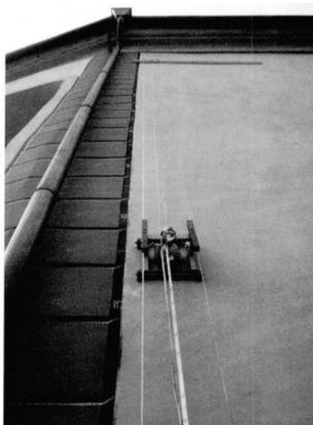
Fig. 2.22 Investigarea pereților prin metoda geo-magnetică [31]
