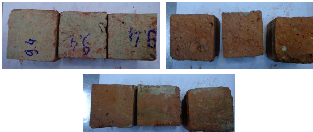
Fig. 6.98 Extragerea epruvetelor cubice din probele de cărămidă 9.4.
