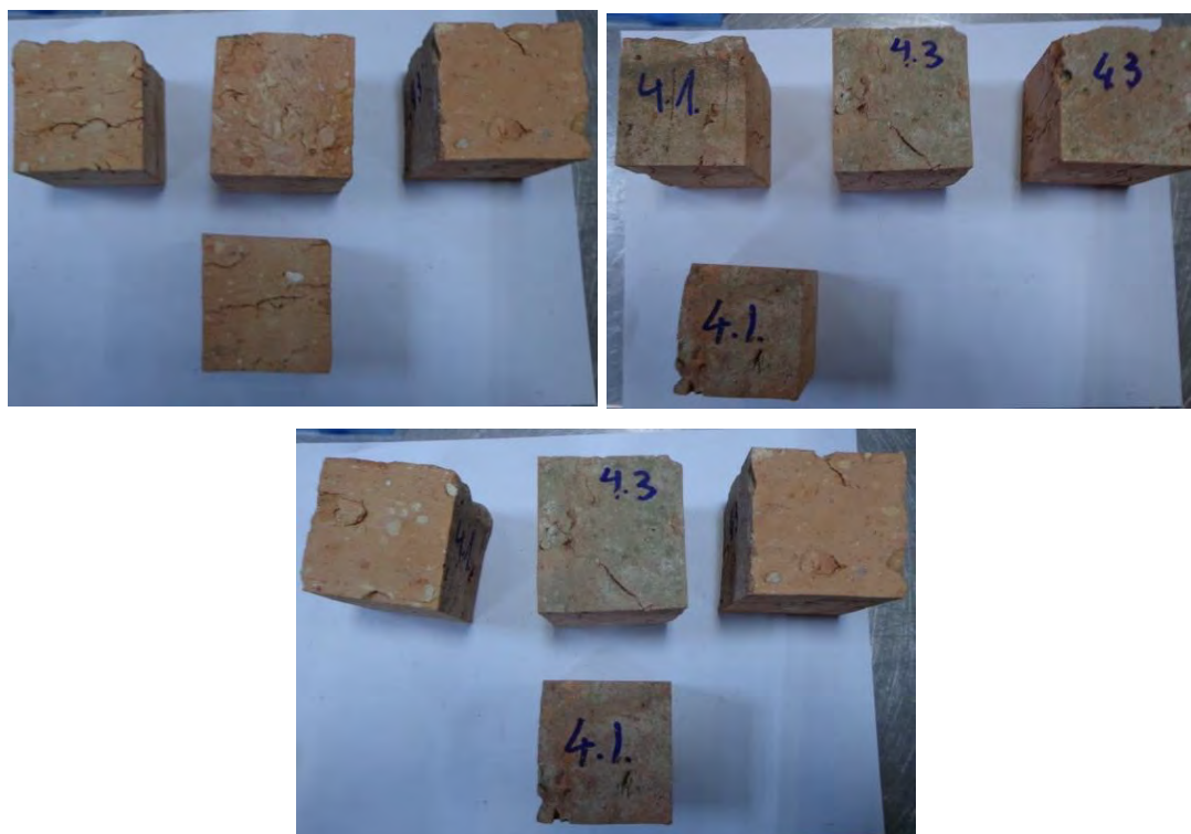
Fig. 6.46 Extragerea epruvetelor cubice din probele de cărămidă 4.1 și 4.3
