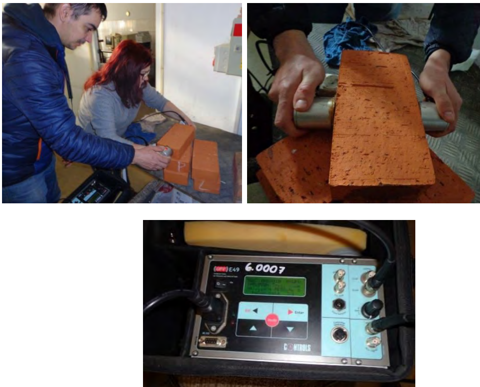
Fig. 6.7 Efectuarea testelor UPV cu aparatul E49
