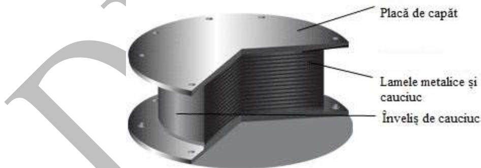
Fig. 2.1 Izolator cu amortizare mică [30]
