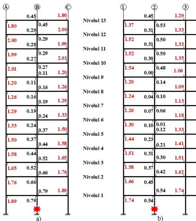
Figura 4.16 Valorile raportului DCR la forță tăietoare pentru cazul de avarie C 4 : a) cadrul transversal CT 2 și b) cadrul longitudinal CL B , pentru modelul avariat Brăila P13-70
