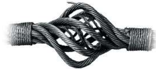
Figura 1.23 Exemplu de deformare a cablului de tip colivie, reprodus din [17].
