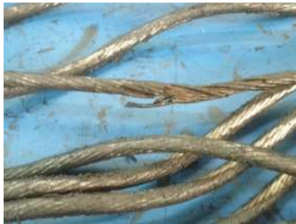
Figura 1.20 Exemplu toron-inimă rupt și toroane exterioare intacte, reprodus din [22].
