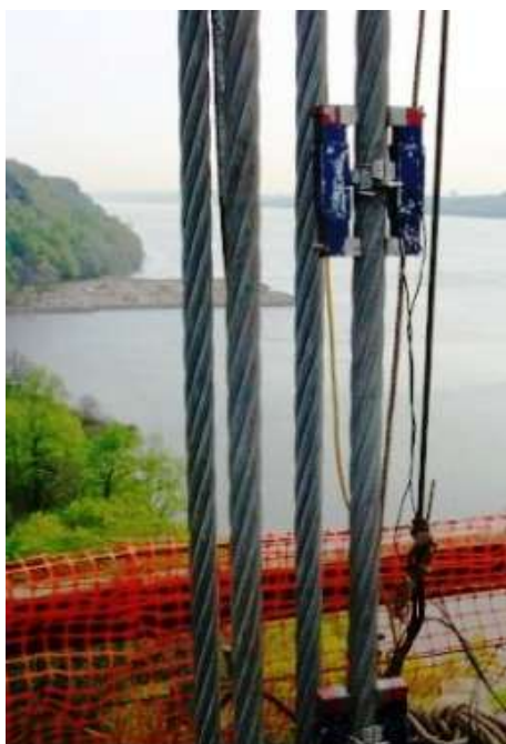
Figura 2.27 Amplasare în situ a sistemului Cable-Scan, reprodus din [70].
