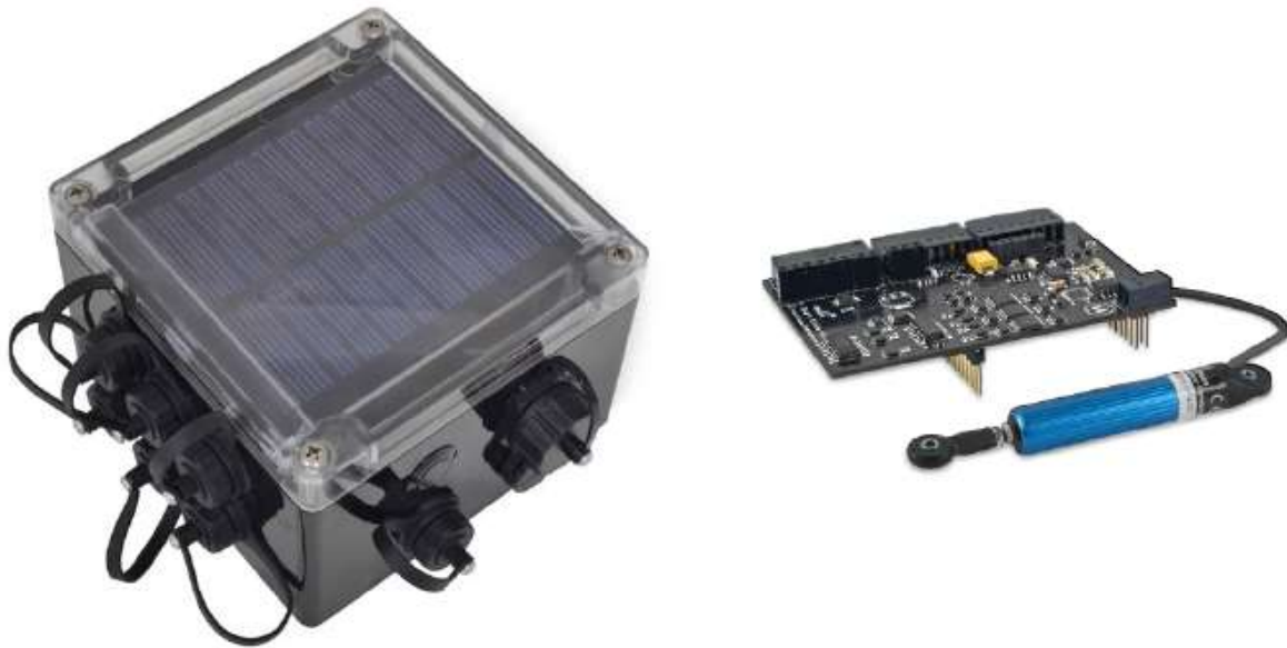
Figura 3.5 Nod WSN dotat cu mini-panou solar intern.
