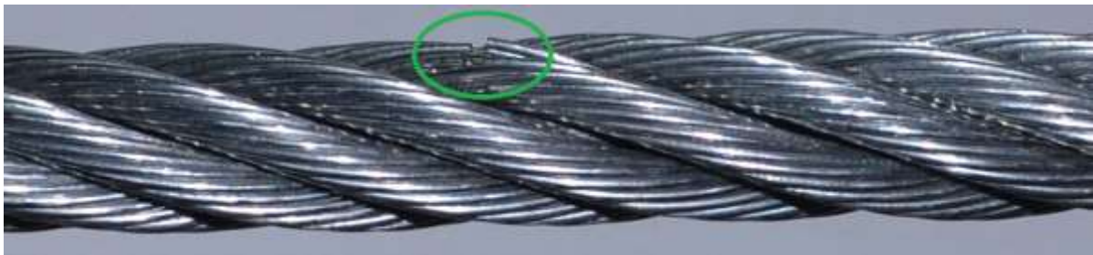
Figura 4.9 Fir individual rupt, atasat la toron.
