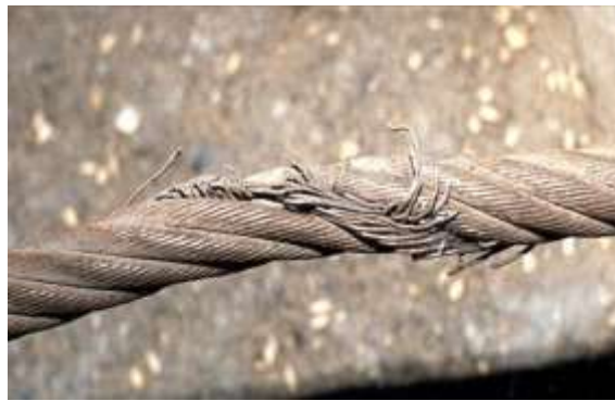
Figura 1.19 Exemplu de ruptură la nivelul unui toron extern.
