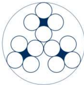
Figura 1.3 Structura primului cablu metalic, redesenat din [10].
