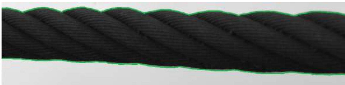
Figura 4.7 Conturul unui cablu neafectat de abraziune.
