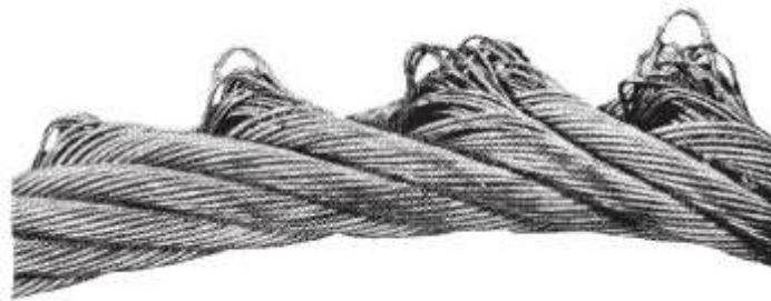
Figura 1.24 Cablu cu inima ieșită spre exterior, reprodus din [8].
