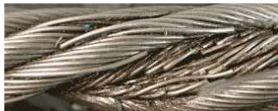
Figura 1.21 Exemplu de cedare a unui toron de tip inimă.
