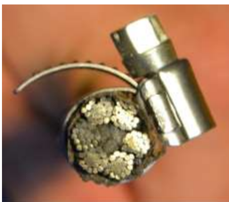
Figura 4.1 Secțiune de cablu din oțel, tip 6 x 19 + FC, utilizat în experimente.
