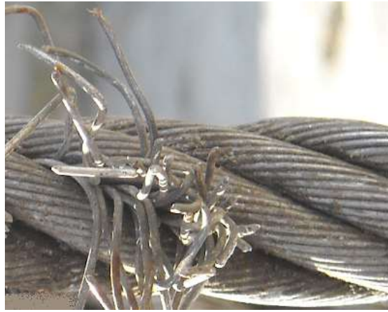
Figura 1.18 Exemplu de toron rupt la interfața cu inima.
