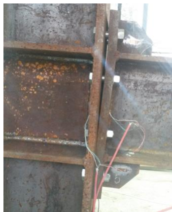
Deformarea îmbinării în urma unui ciclu de solicitare de sus în jos
