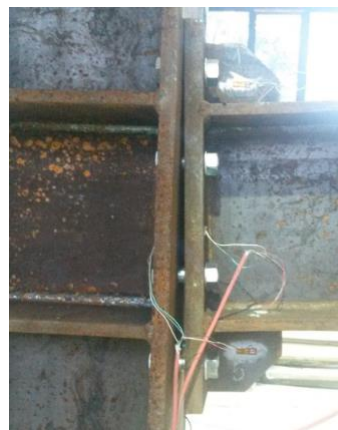
Deformarea îmbinării în urma unui ciclu de solicitare de jos în sus
