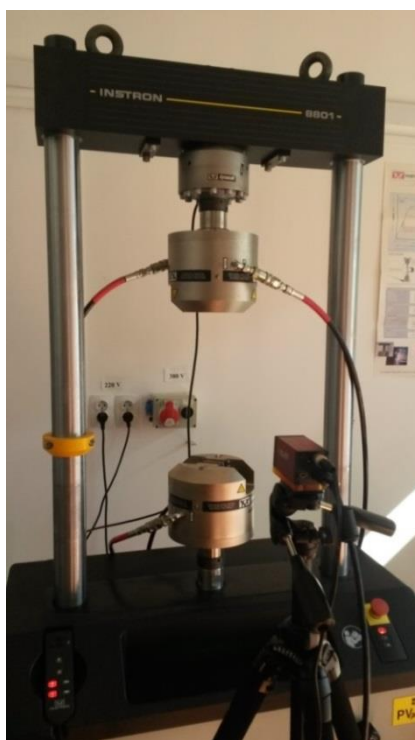
Figura 3-3 Mașina de încercat Instron 8801
