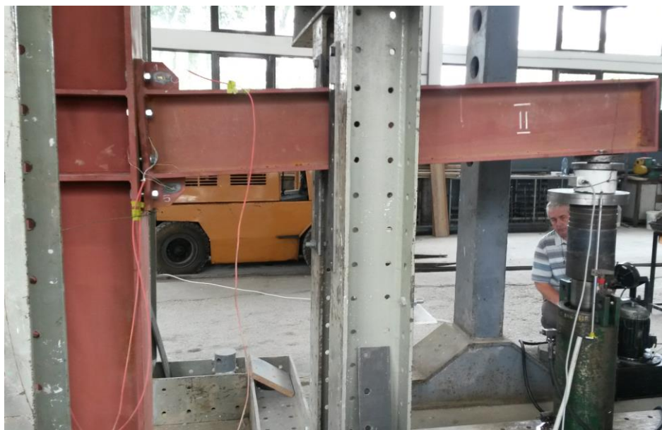
Figura 3-15 Testul 2 – încărcare monoton crescătoare până la cedare – de jos în sus
