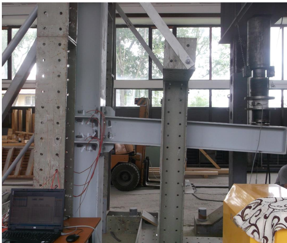
Figura 3-11 Testul 1 – încărcare monoton crescătoare până la cedare – de sus în jos
