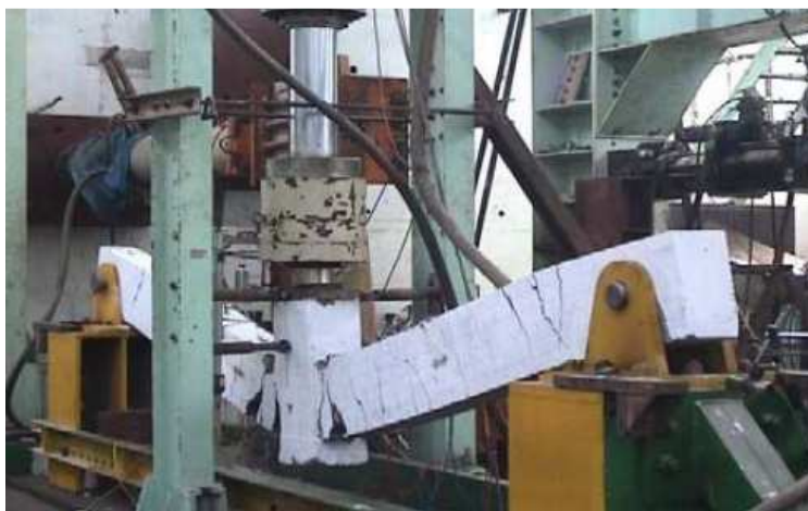
Figura I-12: Subansamblu grindă-stâlp-grindă încercat experimental de He și Yi [19]
