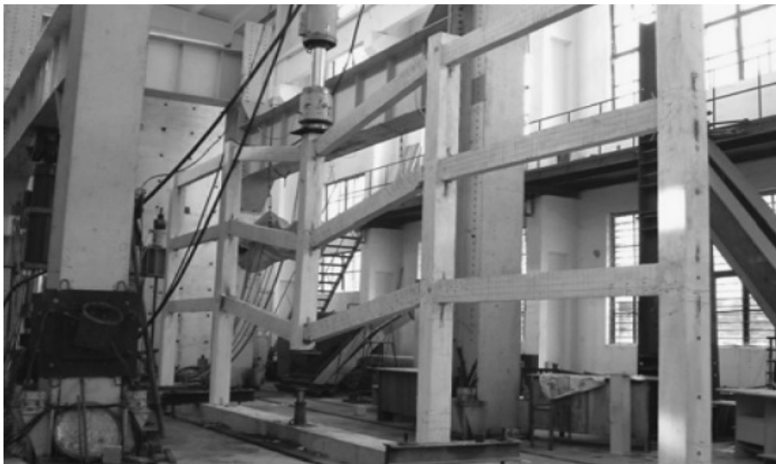
Figura II-17: Cadrul testat experimental de Yi și alții [28]
