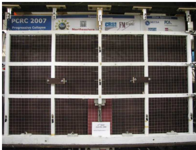
Figura I-15: Cadru plan, scara 1:8, utilizat în studiul experimental static și dinamic [16]
