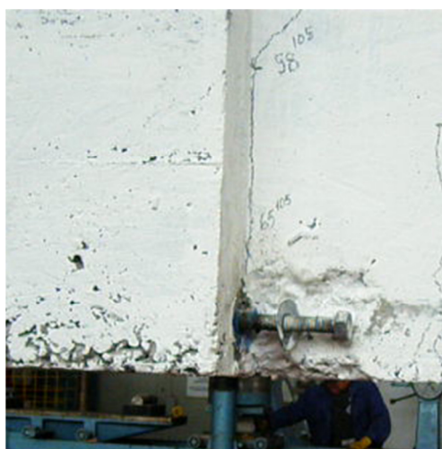
Fig. 3.62 Extragerea unei bare de armătură în cazul probei N2
