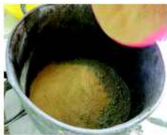
Amestec uscat: liant și agregat fin
