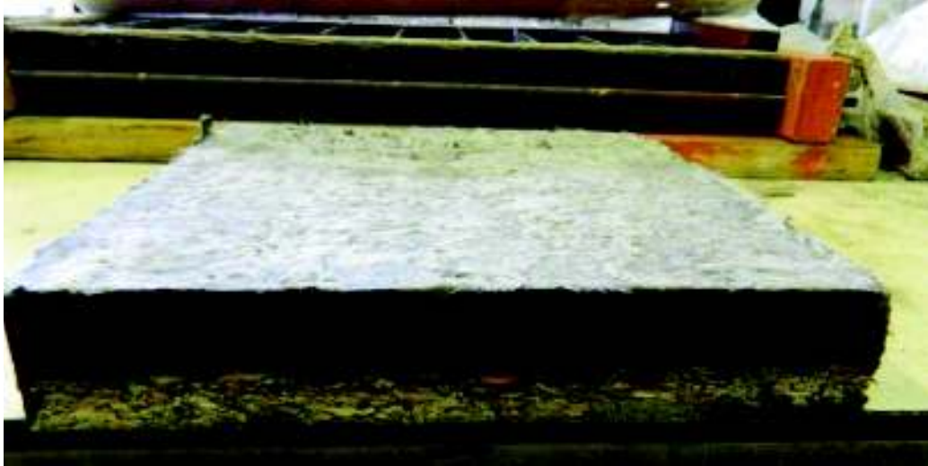
Fig. 4.7. Epruvetă ECC tip placă, decofrare parțială la 24 h
