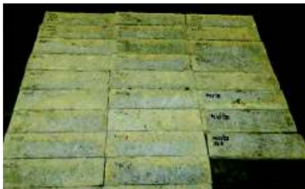
Fig. 5.13. Epruvete prismatice 10x40x160 mm, compoziție ECC M 1.5
