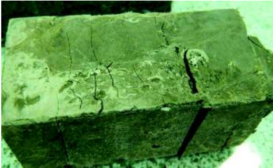
Fig. 3.24 Epruvete prismatice SH – FECM T15 – solicitare la compresiune
