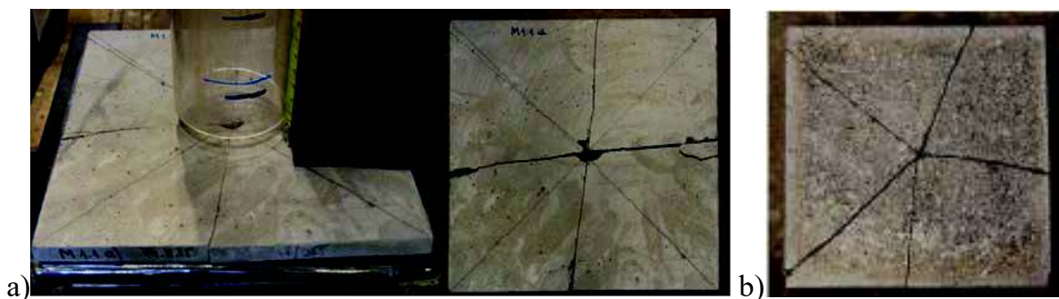
Fig. 6.8. Probe martor (fără fibre) supuse încercării la șoc. cedare casantă după efectuarea primului șoc ( h = 0.5 m): a) compoziția martor M 1.1; b) mortar martor
