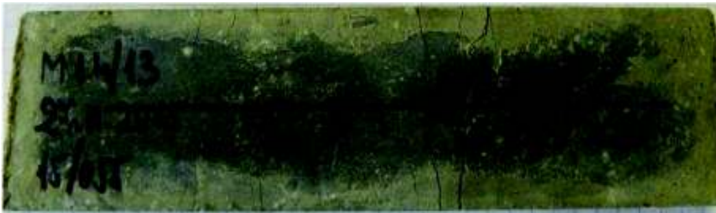
Fig. 5.9. Epruvetă prismatică 10x40x160 mm, compoziție ECC M 1.4, după cedare
