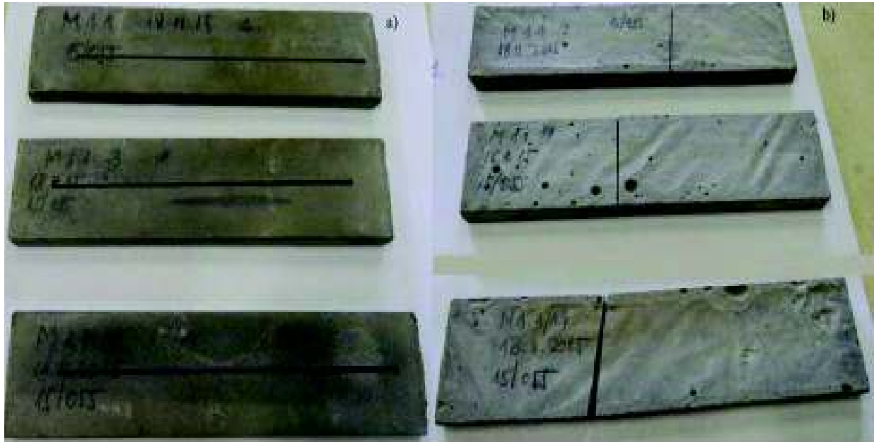
Fig. 5.6. Epruvete prismatice 10x40x160 mm, compoziție martor M 1.1, înainte și după încercare
