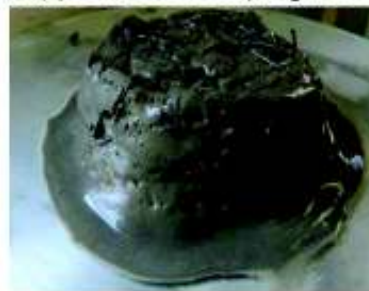
Compoziție SH – FECM T4 (cu fibre) pe masa de împrăștiere
