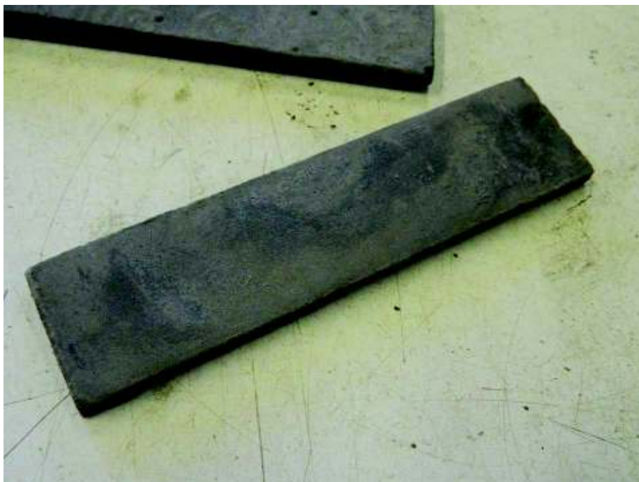
Fig. 5.18. Epruvete prismatice 10x40x160 mm, compoziție mortar M 4.1
