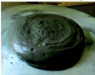
Compoziție SH – FECM T4 (fără fibre) pe masa de împrăștiere
