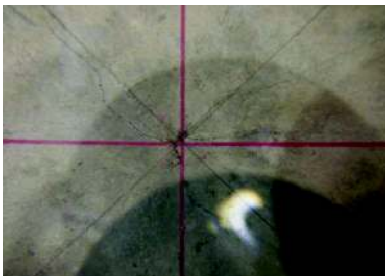
Fig. 6.76. M 2.2 SH, ciclul I, rețea microfisuri
