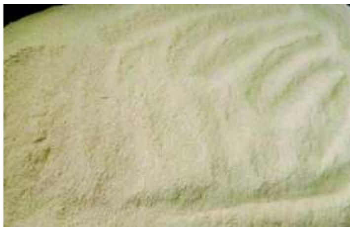
Fig. 3.1. Nisip silicios fin, utilizat la realizarea compozițiilor prototip SH-FECM
