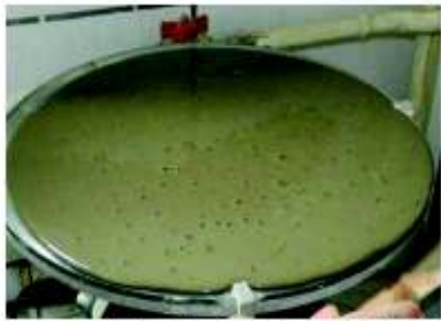
Compoziție SH – FECM T1 (fără fibre) pe masa de împrăștiere
