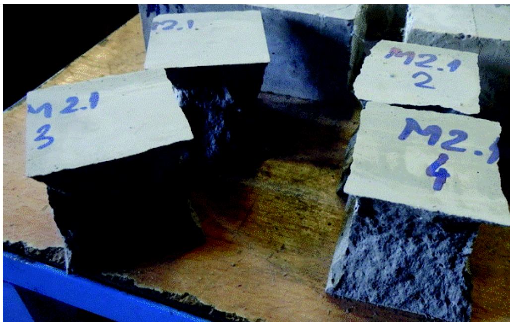
Fig. 4.13. Compoziții martor (fără fibre): epruvete supuse la compresiune: cedare casantă sub sarcină
