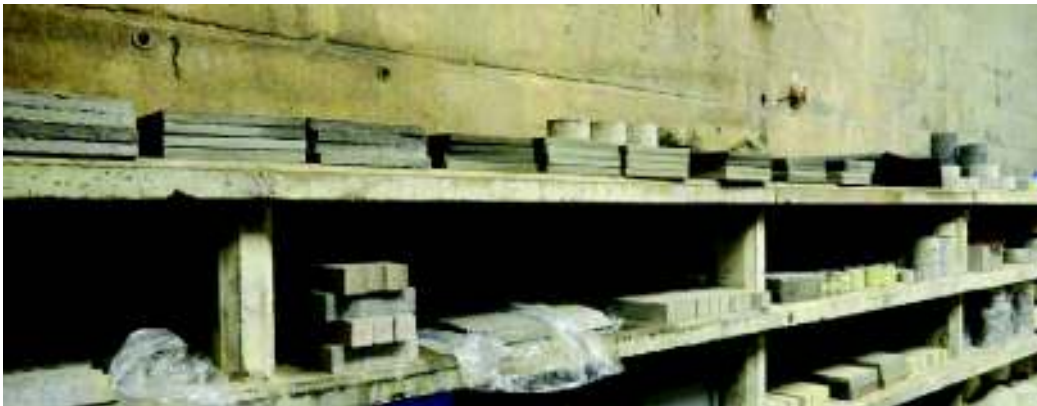
Fig. 4.8. Epruvetă ECC amplasate în incinta de condiționare cu RH 95±5 %
