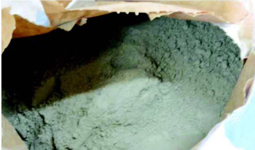
Fig. 3.3. Ciment Portland, utilizat la realizarea compozițiilor prototip SH-FECM
