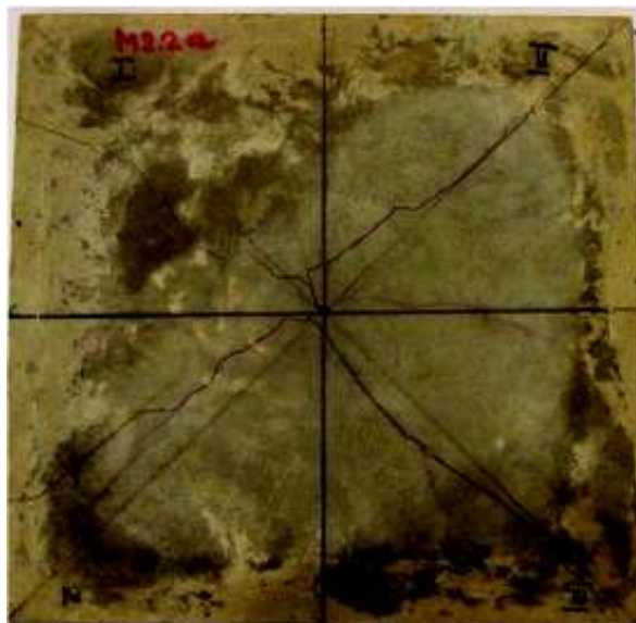
M 2.2 a – 5 x 1.0 m, fața inferioară (detaliu)
