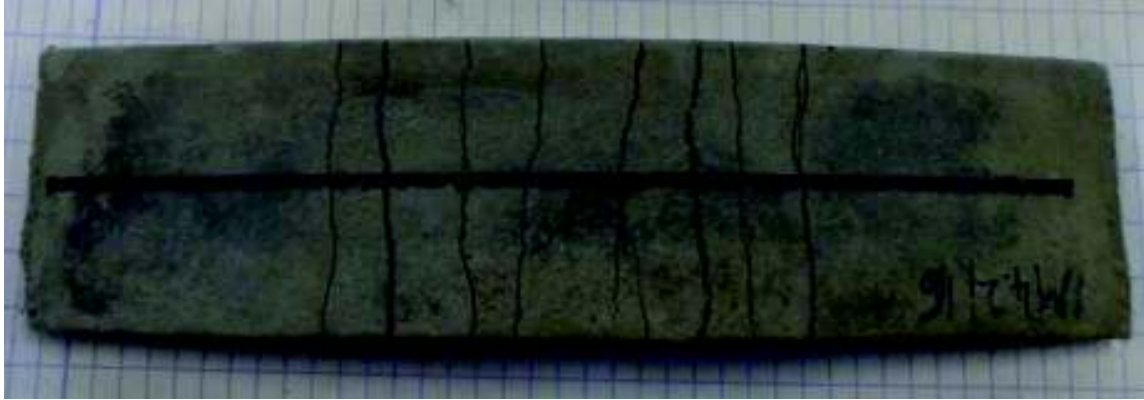
Fig. 5.22. Epruvetă prismatică 10x40x160 mm, compoziție ECC M 4.2, după cedare
