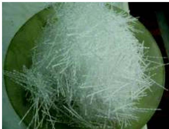
Fig. 3.6. Fibre de polipropilenă MASTERFIBER® 246
