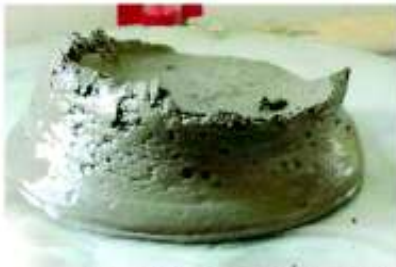
Compoziție SH – FECM T3 (fără fibre) pe masa de împrăștiere
