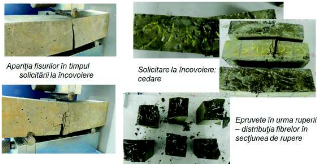
Fig. 3.12 Epruvete prismatice după testarea la întindere prin încovoiere
