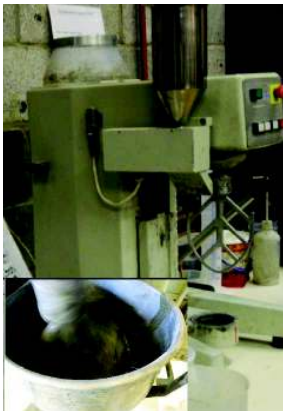
Fig. 4.2. Malaxor cu paletă conform EN 196-1 [73] (Laboratorul Magnel)
