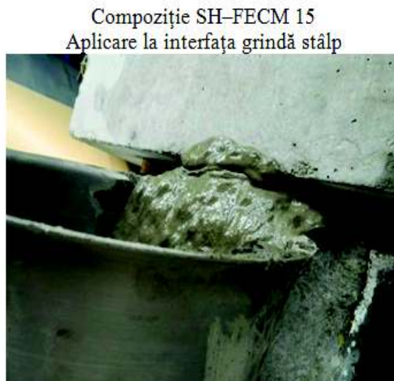
Fig. 3.18 Compoziție SH – FECM T15 – stare proaspătă
