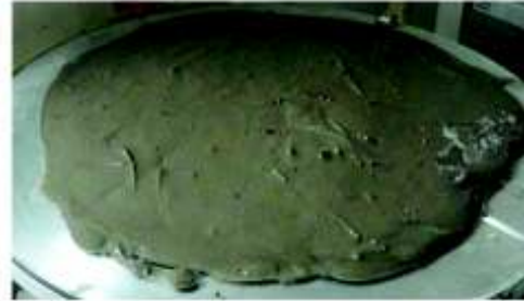
Compoziție SH – FECM T1 (cu fibre) pe masa de împrăștiere
