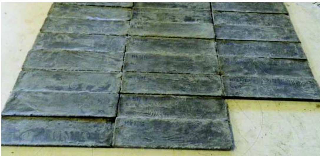
Fig. 5.21. Epruvete prismatice 10x40x160 mm, compoziție ECC M 4.2
