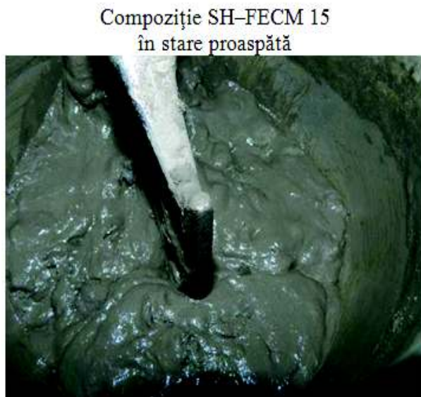
Fig. 3.18 Compoziție SH – FECM T15 – stare proaspătă
