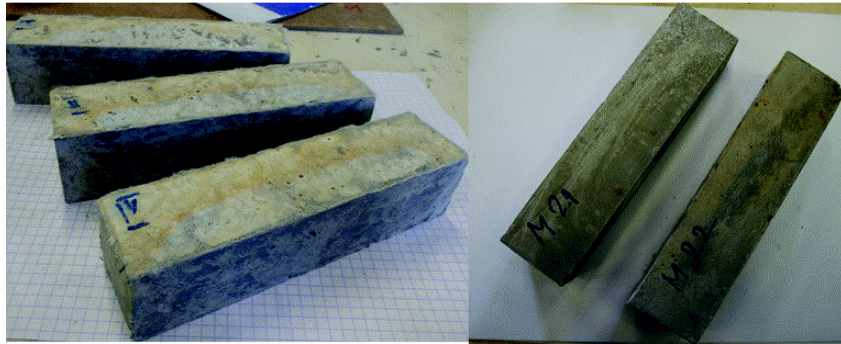
Fig. 4.10. Compoziții ECC: Epruvete 40 x 40 x 160 mm
