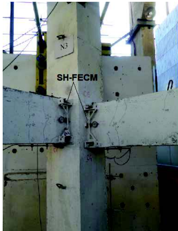
Fig. 3.14 Nodul hibrid antiseismic – detaliu de colț, îmbinare grindă-stâlp
