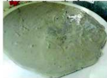
Compoziție SH – FECM T2 (cu fibre) pe masa de împrăștiere
