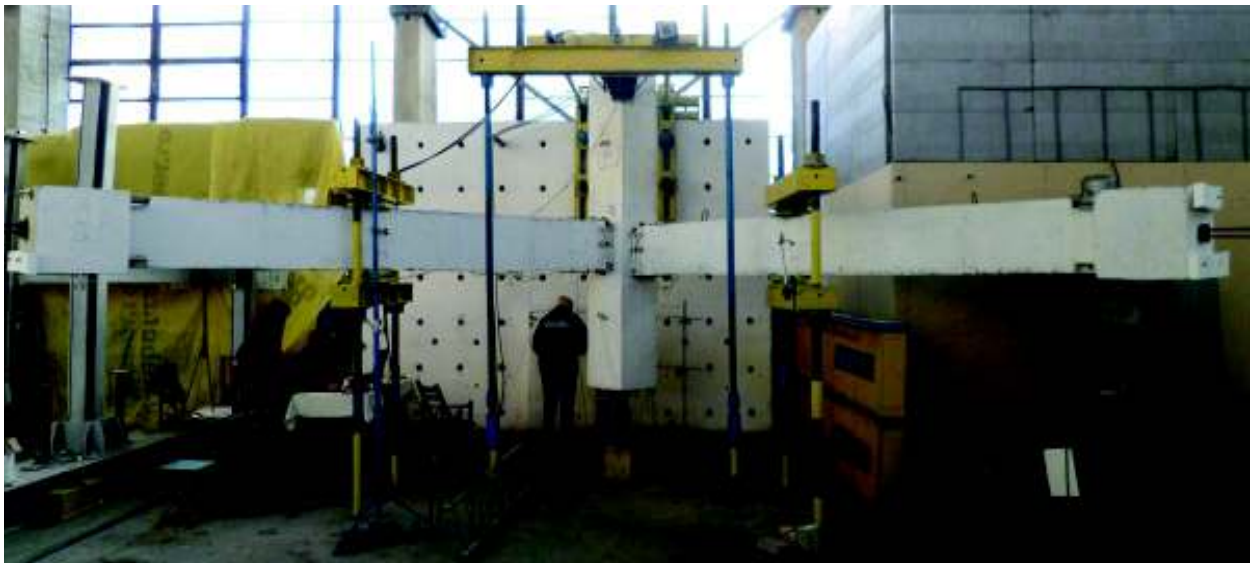
Fig. 3.13 Nodul hibrid antiseismic - ansamblu
