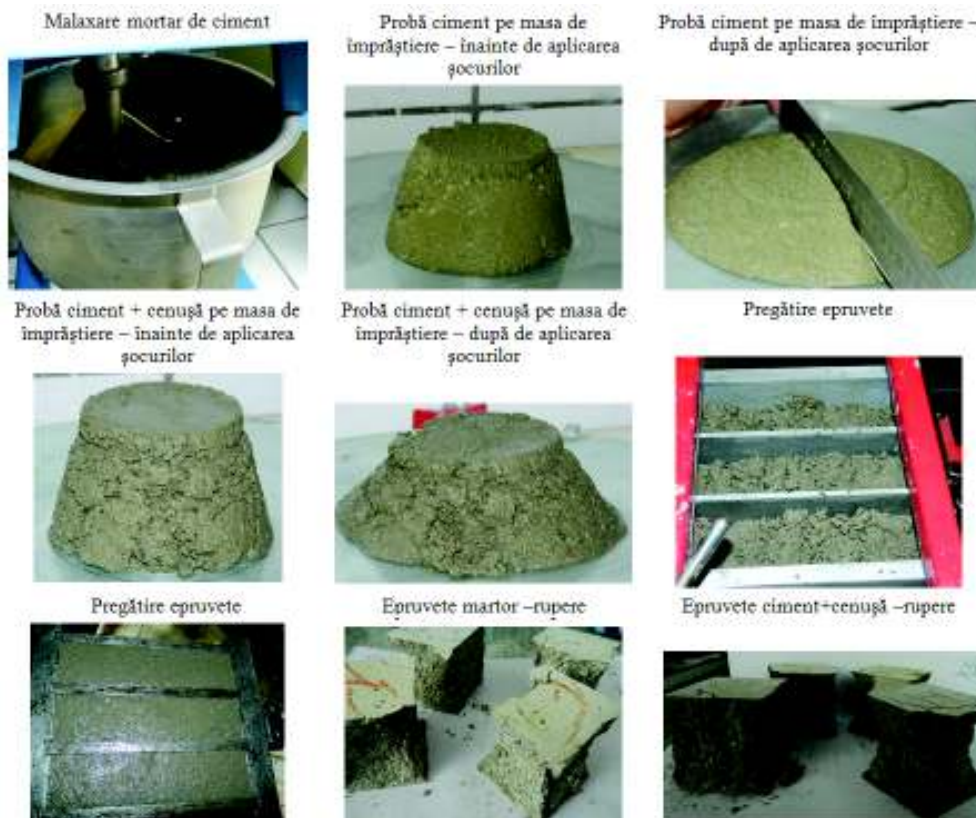
Fig. 3.5. Prepararea / testare probelor de ciment și ciment + cenușă
