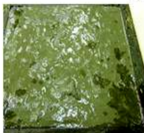
Fig. 4.5. Turnare experimentală ECC: plăci 200x200x15 mm (DWT -2)
