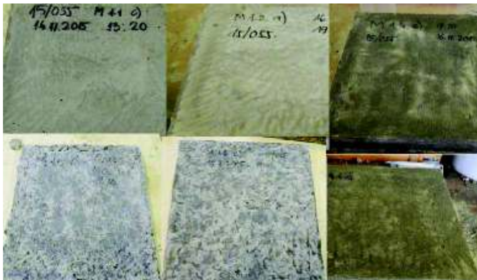
Fig. 6.3. Epruvete ECC tip placă cu dimensiunile 200×200×15, după decofrare
