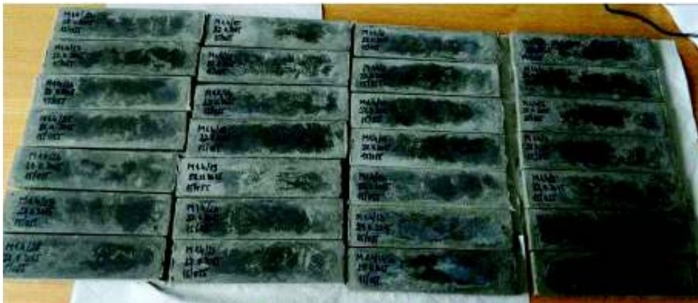
Fig. 5.8. Epruvete prismatice 10x40x160 mm, compoziție ECC M 1.4
