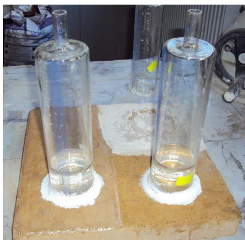
c. cu soluție de grăsime animală, ceara în ulei de in desicativat
