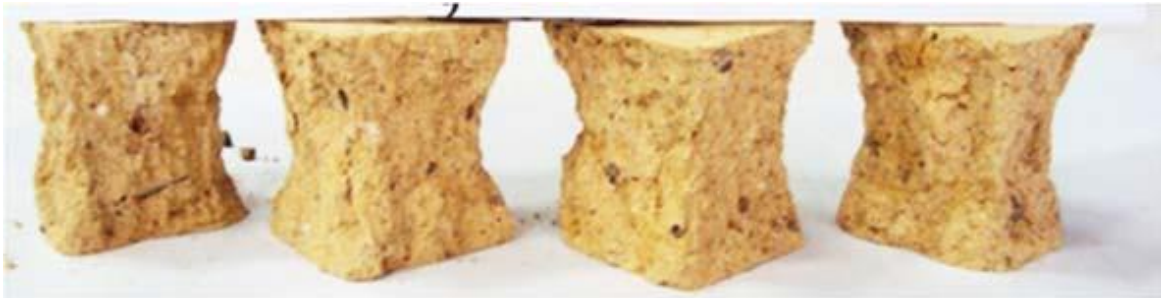
Fig. 5.6 Aspectul epruvetelor după determinarea rezistenței la compresiune
