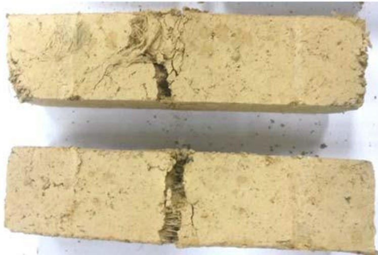
a. epruvete după solicitare la încovoiere
