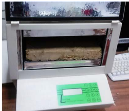
Fig. 5.7 Determinarea conductivității termice prin metoda termofluxometrică
