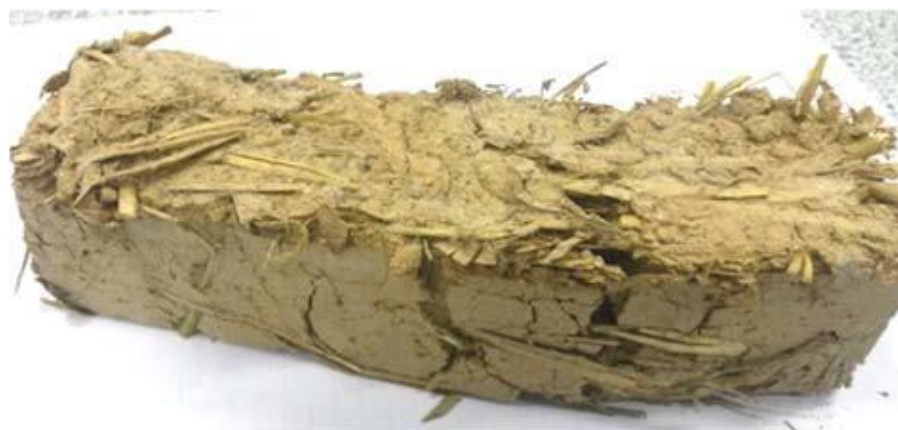
a. epruvete după solicitare la încovoiere
