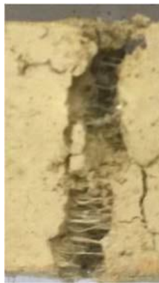
a. epruvete după solicitare la încovoiere
