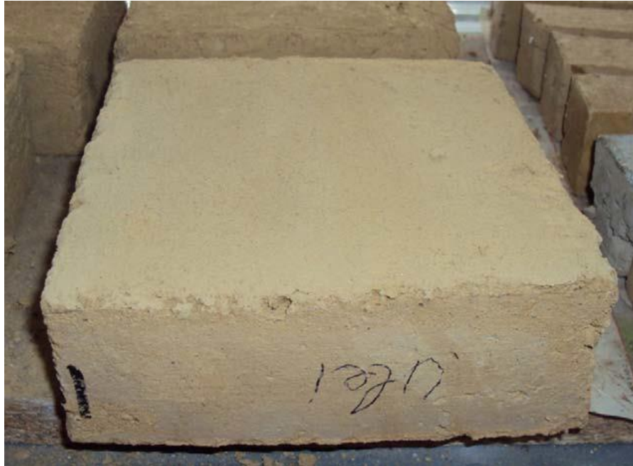
Fig. 5.30 Tencuiala de argilă cu adaos de ulei în compoziția proaspătă.
