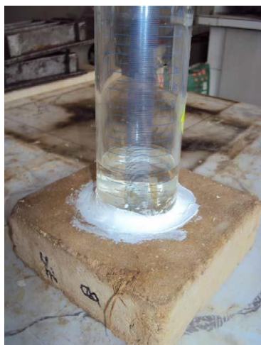
a. cu soluție de ceară dizolvată în petrol
