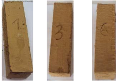
Fig. 5.9 Exemple de epruvete realizate din amestecurile de pământ – nisip - apă
