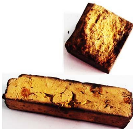
Fig. 5.8 Aspectul epruvetei după tratament termic în flacără deschisă
