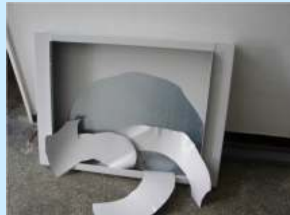
Efecte ale ciclurilor de incercare de caldura umeda
