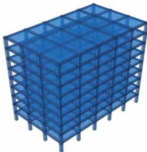
Fig. 4.12. Structură 9 niveluri (P+8E)
