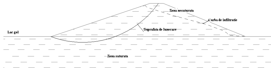
Figura 6.13 Model calcul stabilitate în ipoteza scăderii bruște a nivelului apei în lac de la nivelul maxim la 0. Mișcare anterioară scăderii este considerată cvasipermanentă
