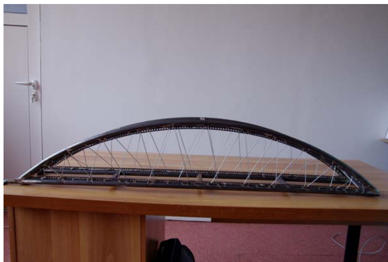
Fig. 229 Modelul cu tiranți înclinați cu înclinație variabilă, având unghiul de 70 grade
