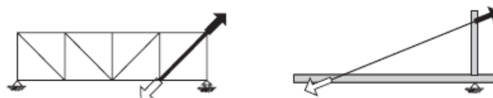
Fig. 110 Sistem cu elemente încărcate axial
