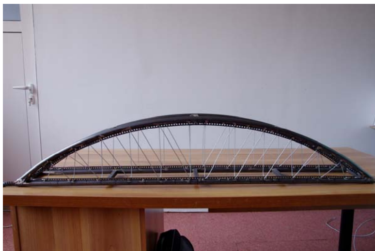
Fig. 233 Model la scara arc cu tiranți înclinați dublati
