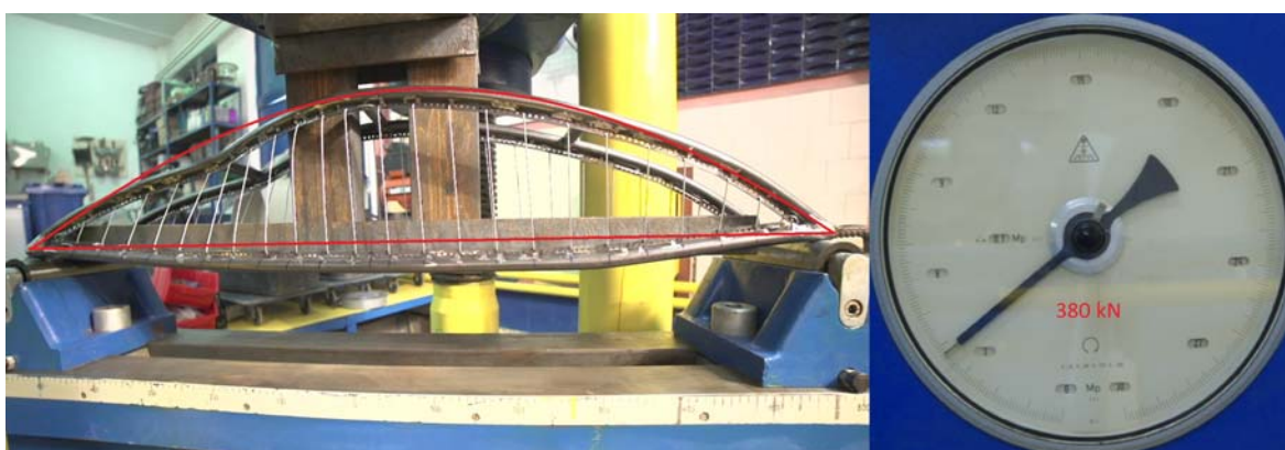
Fig. 208 Momentul cedării la modelul cu tiranți verticali
