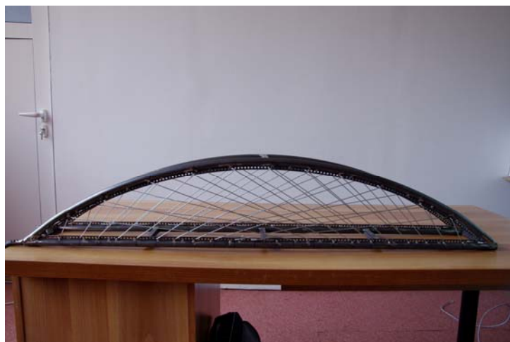
Fig. 227 Modelul cu tiranți înclinați cu înclinație variabilă, având unghiul de 50 grade
