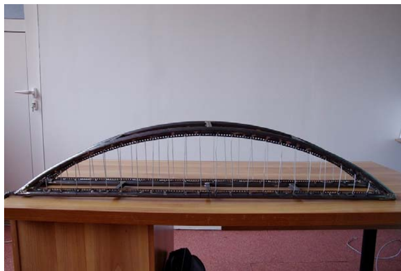
Fig. 207 Model la scara arc cu tiranți verticali
