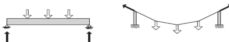
Fig. 111 Sistem cu elemente încărcate transversal
