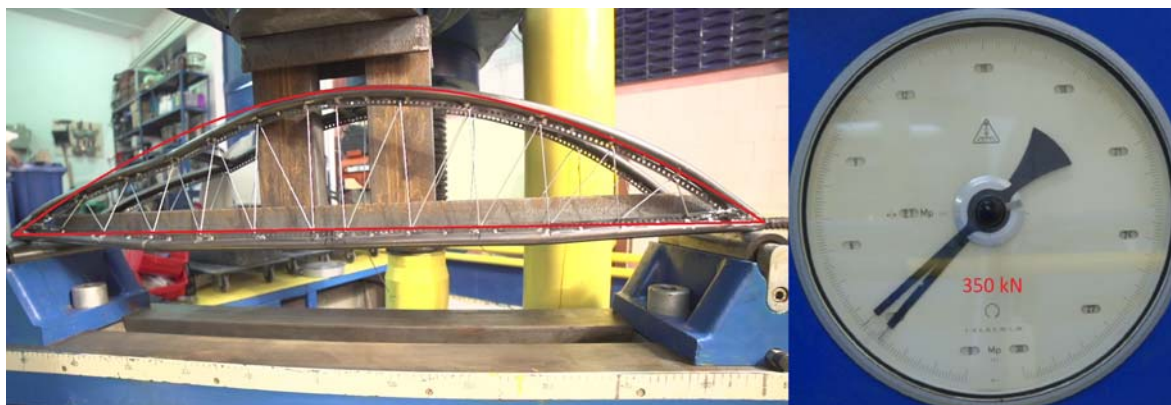
Fig. 234 Momentul cedării la modelul cu tiranți înclinați dublati
