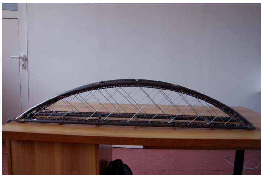
Fig. 216 Model la scara arc cu tiranți înclinați paraleli
