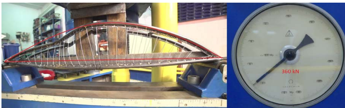
Fig. 232 Momentul cedării la modelul cu tiranți tip spițe
