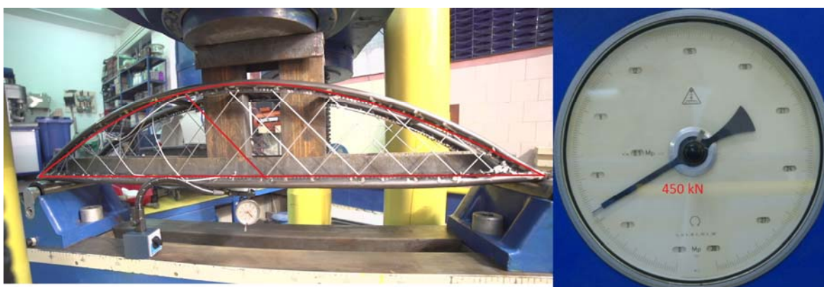
Fig. 217 Momentul cedării la modelul cu tiranți înclinați paraleli
