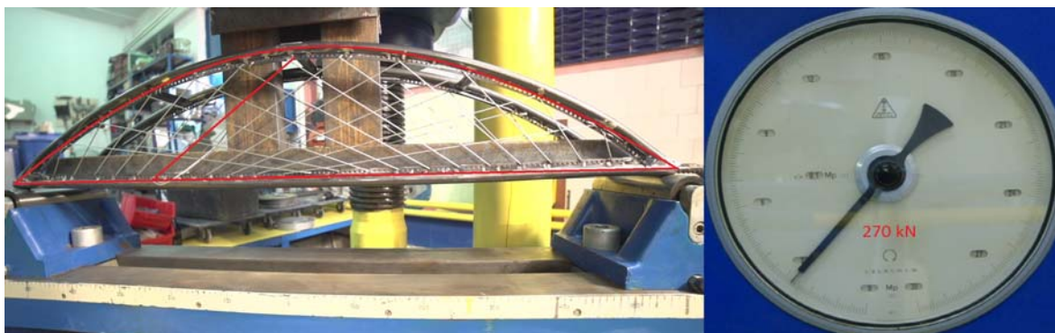
Fig. 228 Momentul cedării la modelul cu tiranți înclinați cu înclinație variabilă, având unghiul de 50 grade
