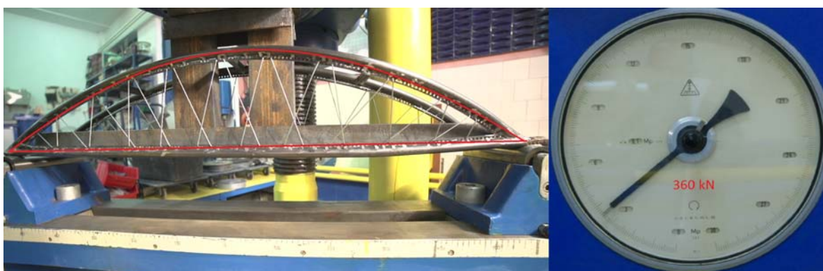
Fig. 230 Momentul cedării la modelul cu tiranți înclinați la 70 grade
