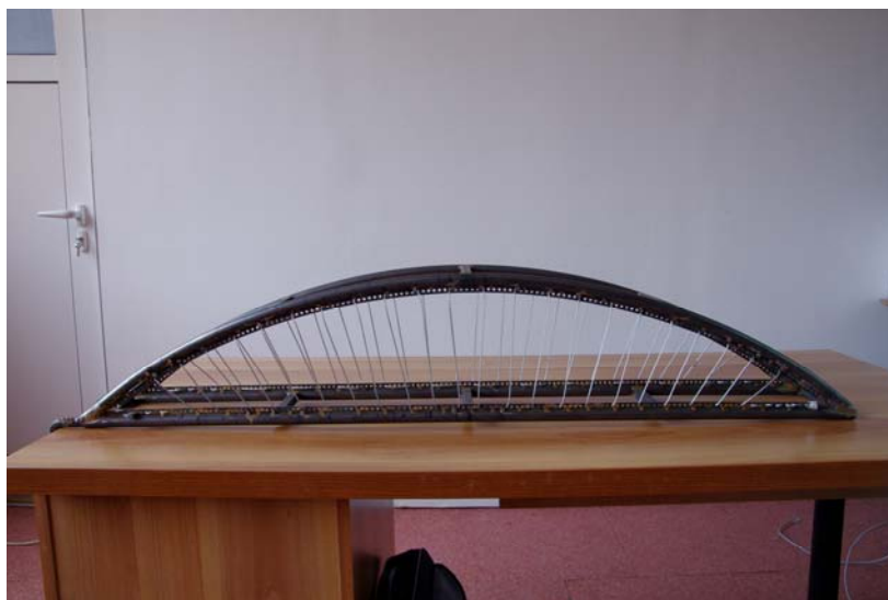
Fig. 231 Momentul cedării la modelul cu tiranți tip spițe
