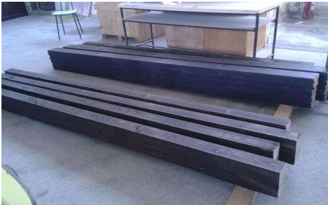
Fig. 4.30- Probele vopsite pentru contrast, pregătite pentru testare
