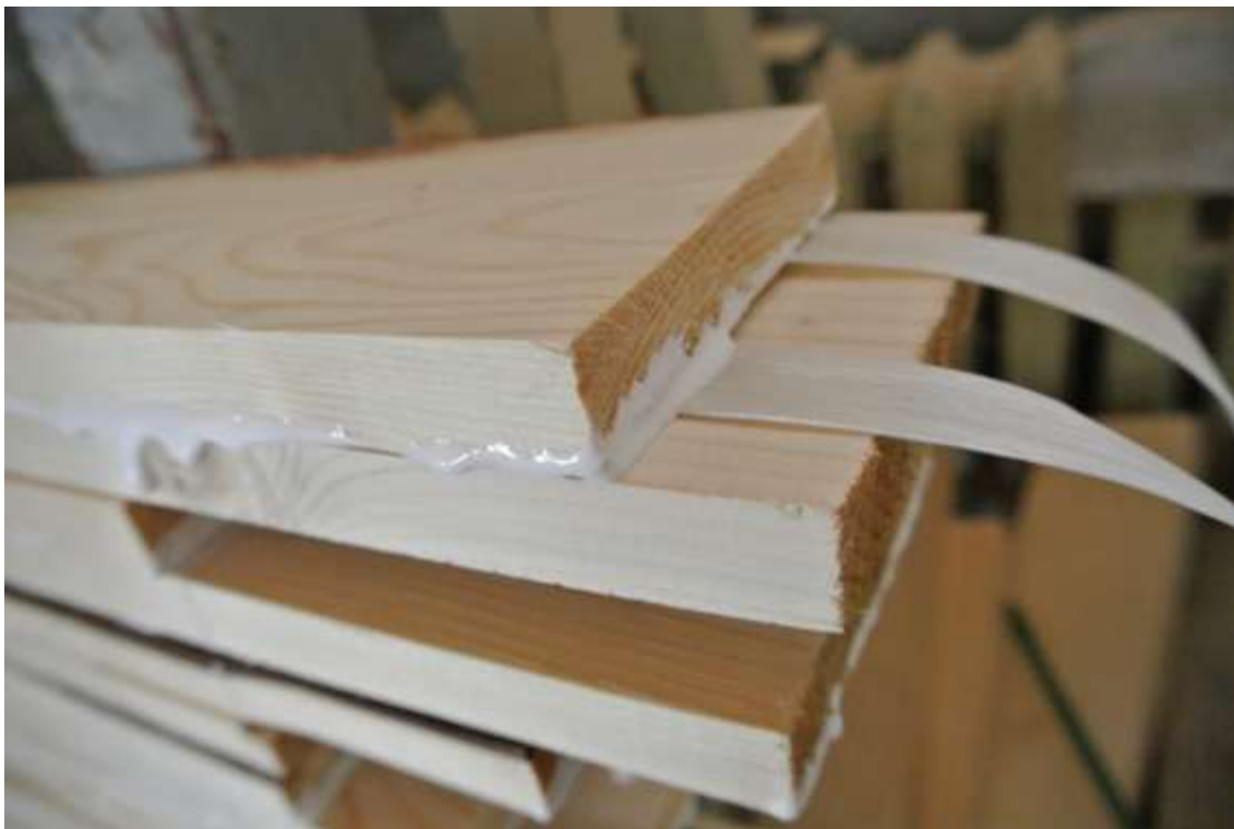
Fig. 4.24- Benzile de armare din fibre de poliester dispuse câte două pe strat
