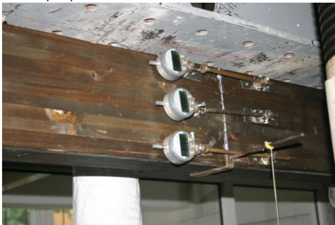
Fig. 4.32- Dispunerea ceasurilor microcomparatoare
