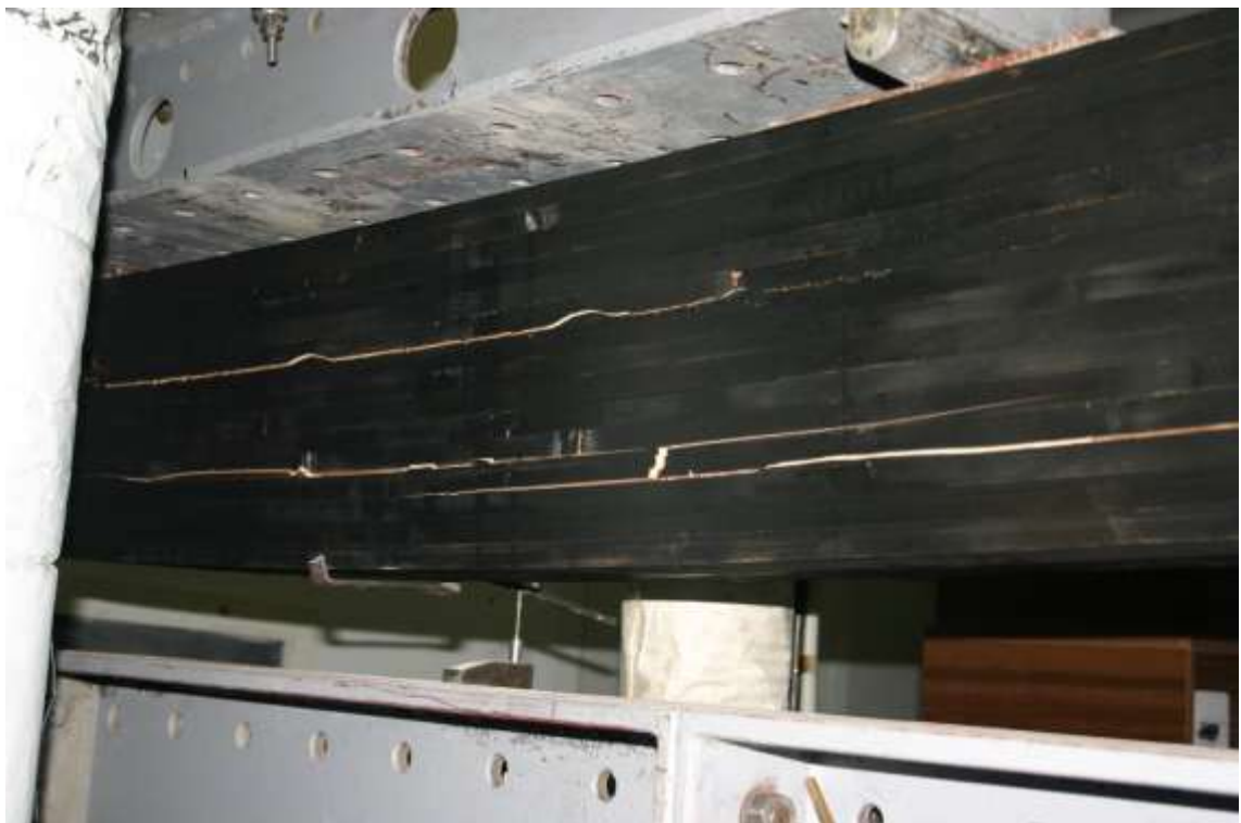
Fig. 4.97- Cedarea probei NR-ABA-1
