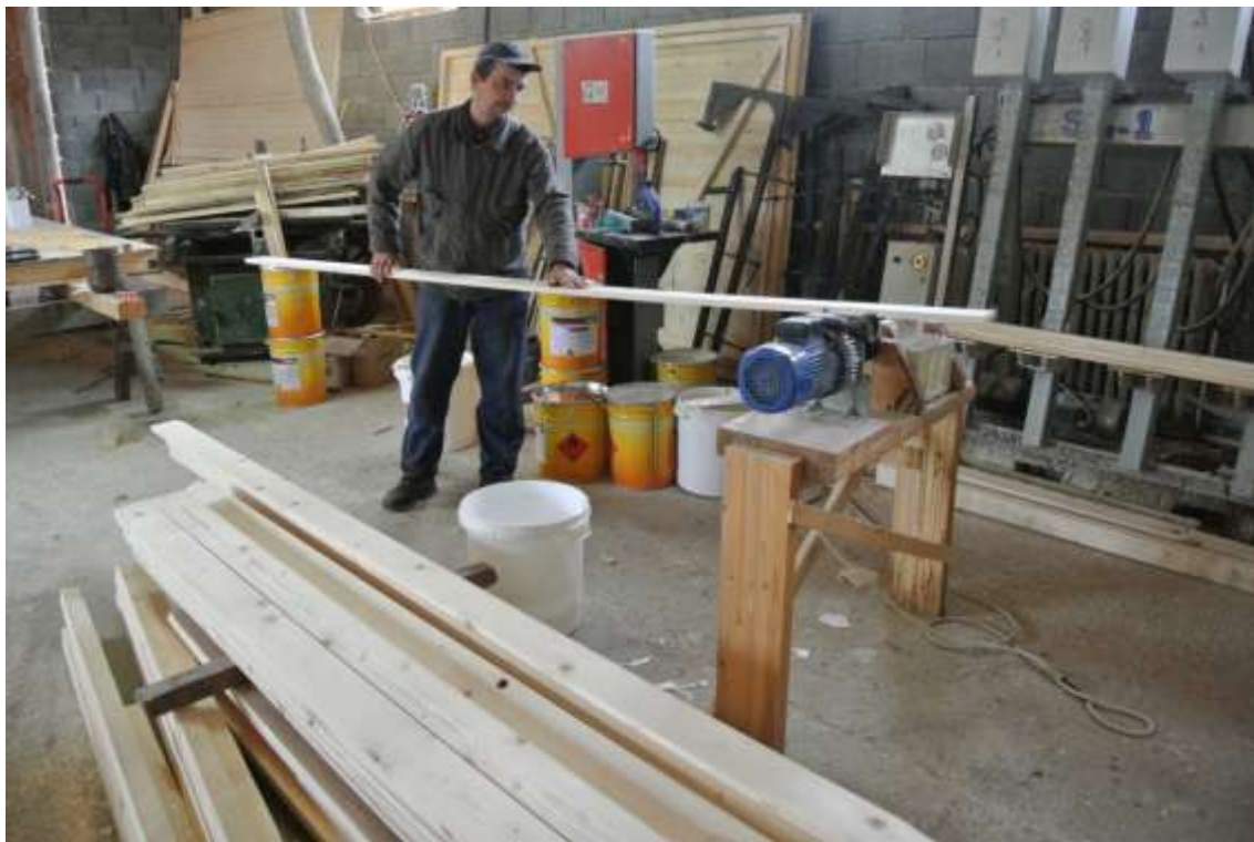
Fig. 4.16- Aplicarea adezivului pe lamelele din lemn
