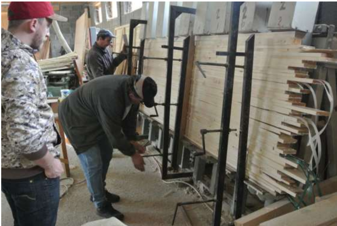
Fig. 4.26- Asigurarea planeității în plan vertical, înainte de presare
