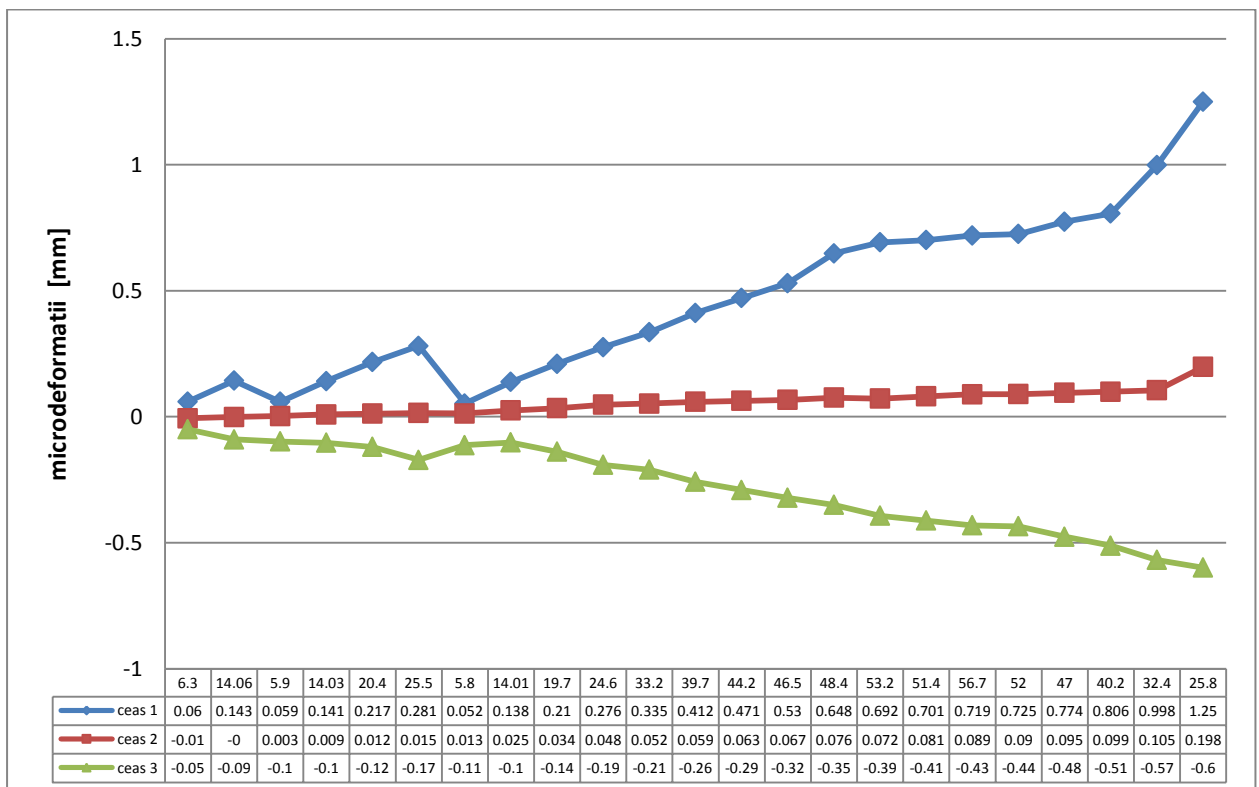
Fig. 4.76- Microdeformații în funcție de încărcare pentru proba R-FIBP-2
