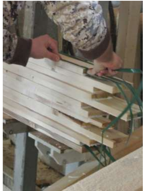
Fig. 4.19- Așezarea și prinderea benzilor de PET prin capsare la capete
