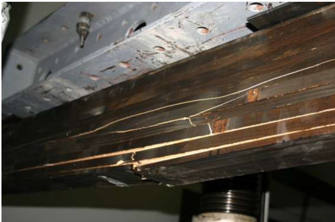
Fig. 4.80- Cedarea probei R-FIBP-2
