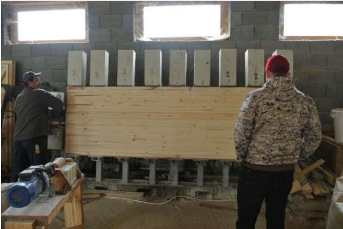
Fig. 4.25- Pregătirea probelor pentru presare
