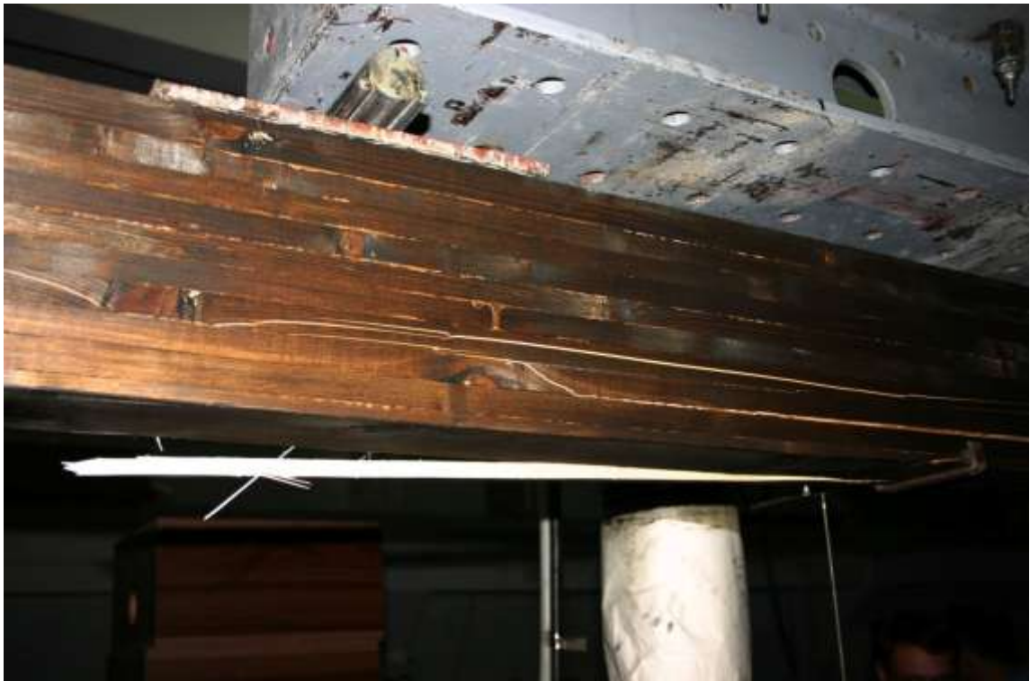
Fig. 4.79- Cedarea probei R-FIBP-1
