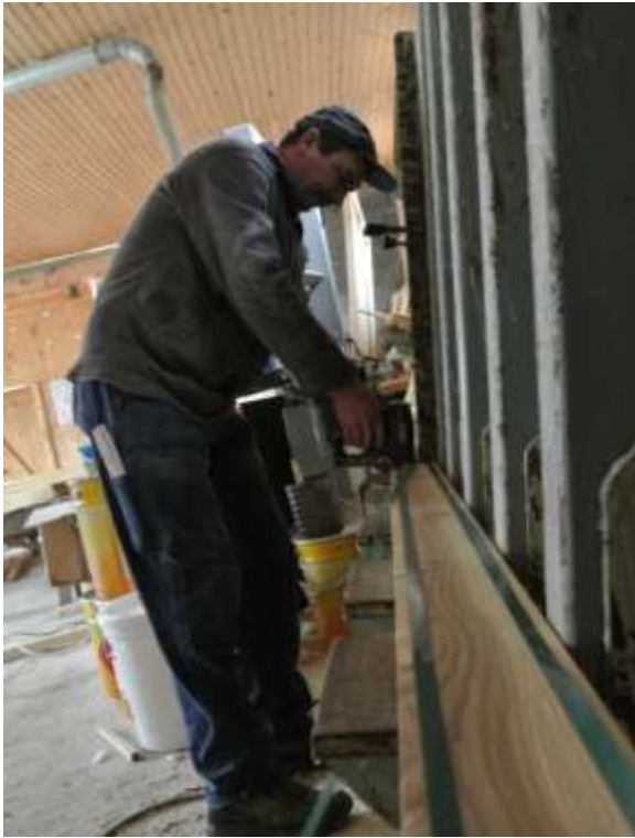
Fig. 4.19- Așezarea și prinderea benzilor de PET prin capsare la capete
