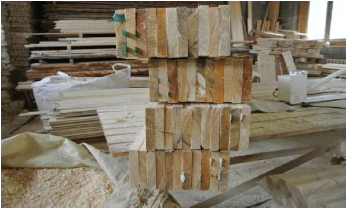
Fig. 4.29- Probele armate vedere în secțiune, înainte de prelucrare la cotele finale
