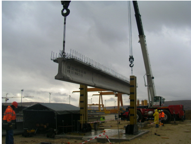
a. poziționare grindă pe standul de încercări
