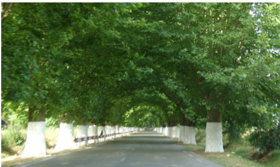
Figura 2.9. Marcarea traseului pe linia de copaci [18]
